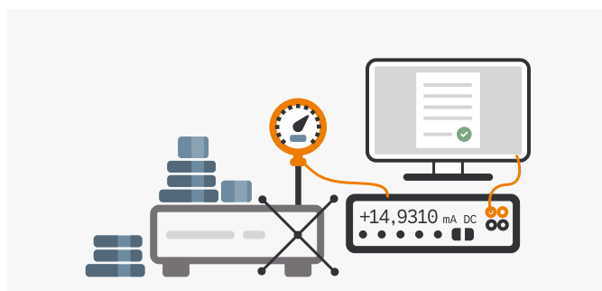
Calibrazione di strumenti di pressione tramite balance di pressione
