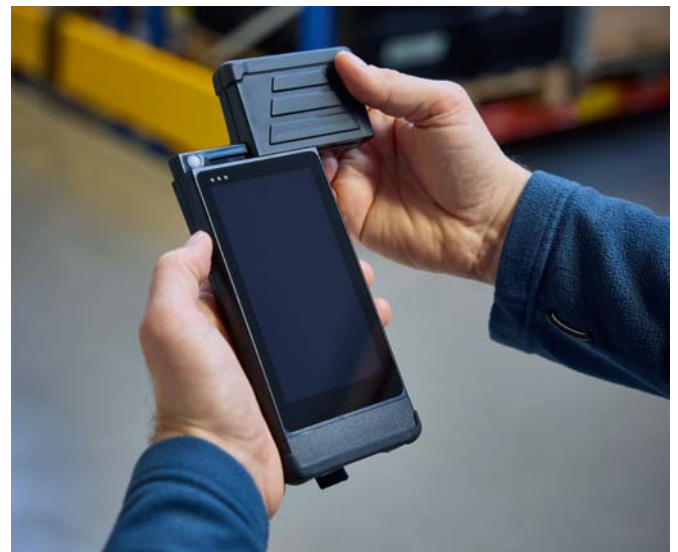
Los distintos módulos de antena situados en la parte superior del lector portátil se pueden sustituir fácilmente.
