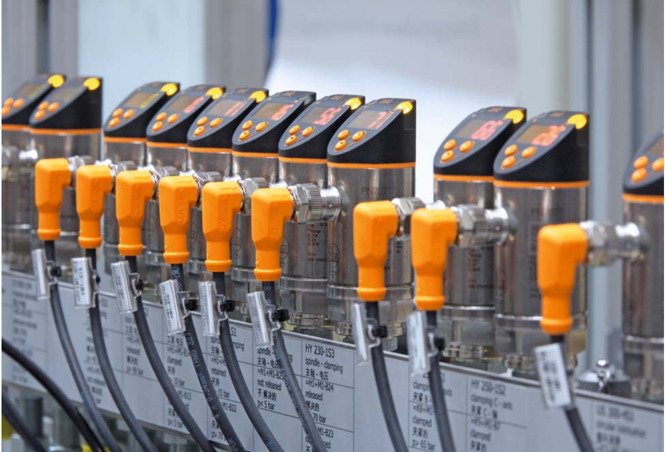
Die zahlreichen IO-Link-Sensoren sind zentral parametrierbar.
