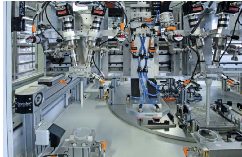
Unterschiedlichste Sensoren überwachen Drücke, Temperaturen und Positionen in der Anlage.
