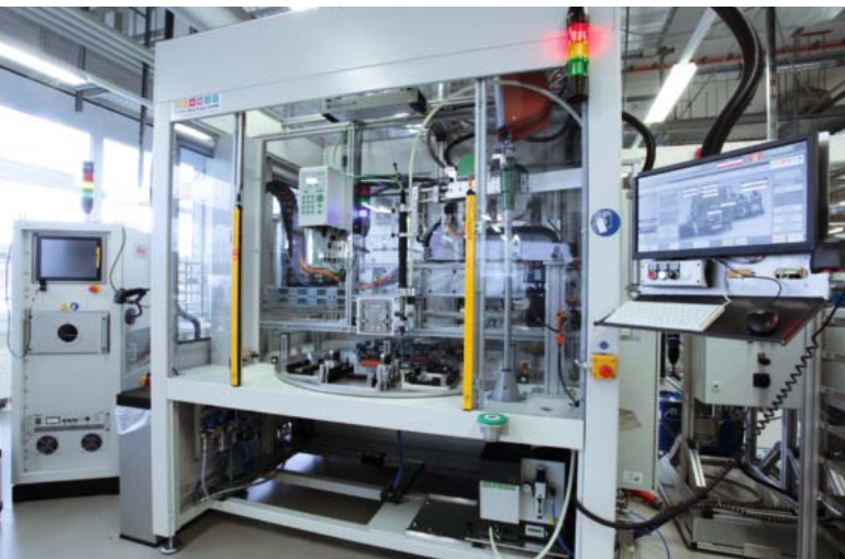
In dieser Anlage werden Wärmeleitpaste und Dichtmasse aufgetragen und das Produkt final zusammengefügt
