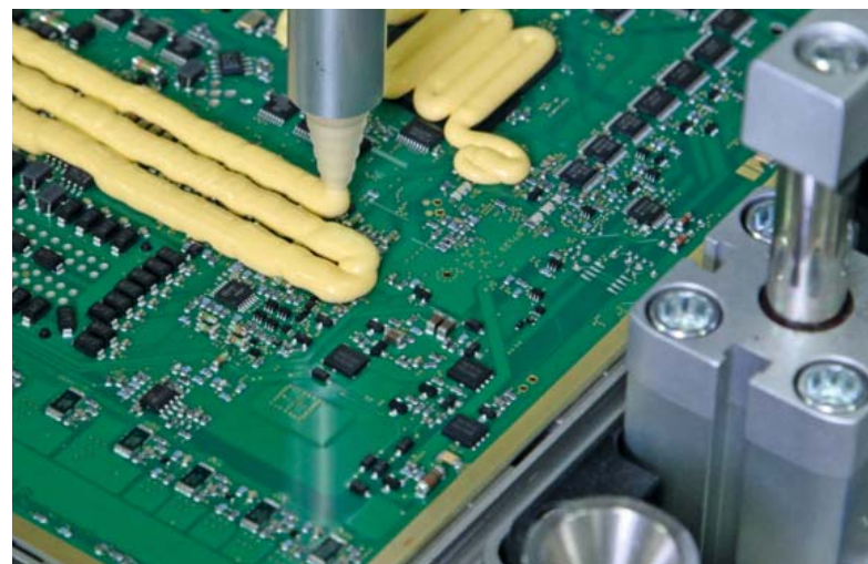
Auftrag der 2-Komponenten-Wärmeleitpaste auf die Leiterplatte.
