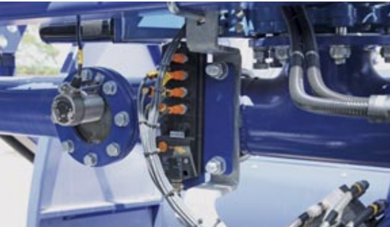
Robuste dezentrale E/A-Module nehmen Sensor-signale auf und leiten sie per CAN-Bus an die SPS.
