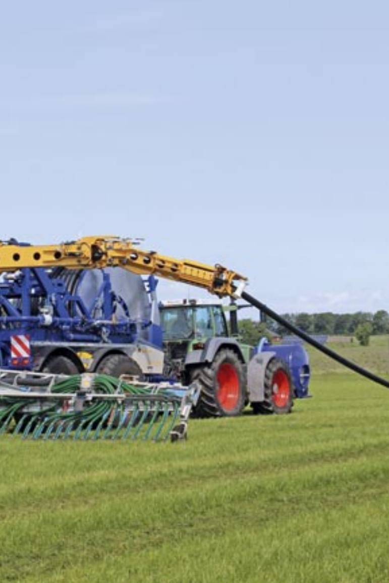
Die Verschlauchungshaspel SRS 1500 wird zur Gülleausbringung von einem Traktor über das Feld gezogen.
