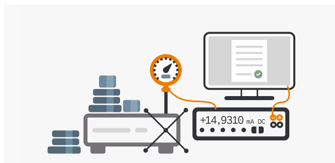
Etalonnage d'appareils de mesure de pression au moyen de balances de pression
