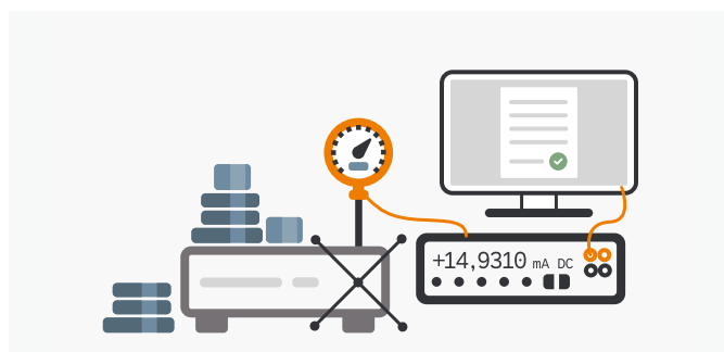
Calibrazione di strumenti di pressione tramite balance di pressione
