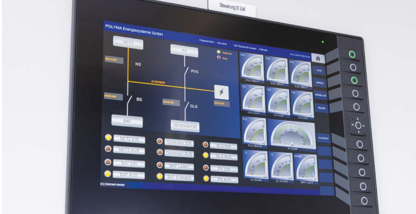
L'écran tactile central CR1204 d'ifm sert à la fois à la visualisation de tous les paramètres de fonctionnement et à la configuration des diverses fonctions.
