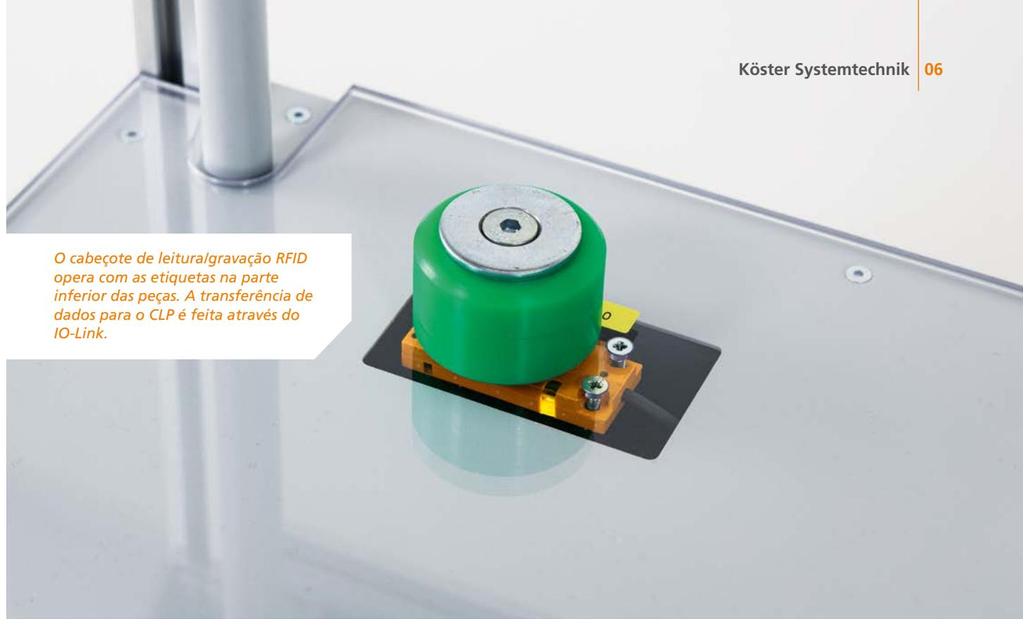
*O cabeçote de leitura/gravação RFID opera com as etiquetas na parte inferior das peças. A transferência de dados para o CLP é feita através do IO-Link.*
