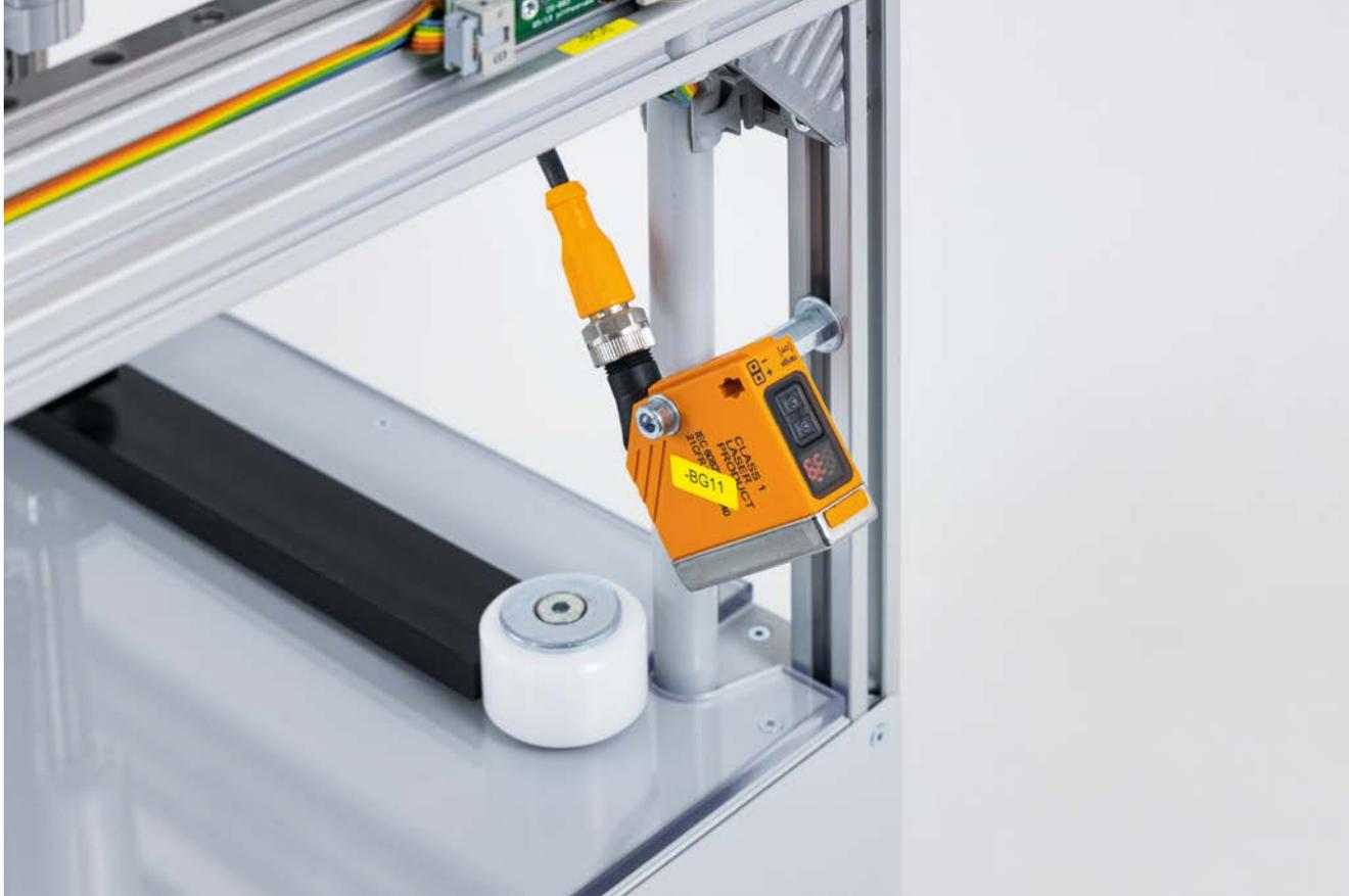
*O sensor de distância a laser transmite valores de distância com precisão de milímetros via IO-Link para o CLP.*
