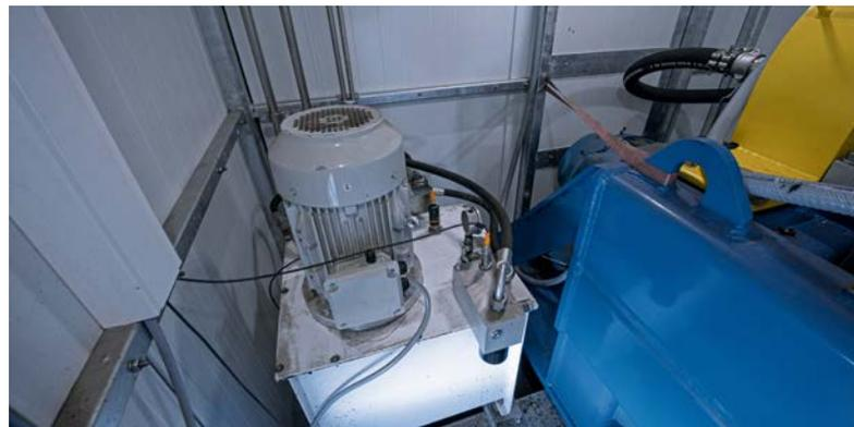
*Das elektrisch angetriebene Hydraulikaggregat für den Schneckenförderer in der Zentrifuge.*
