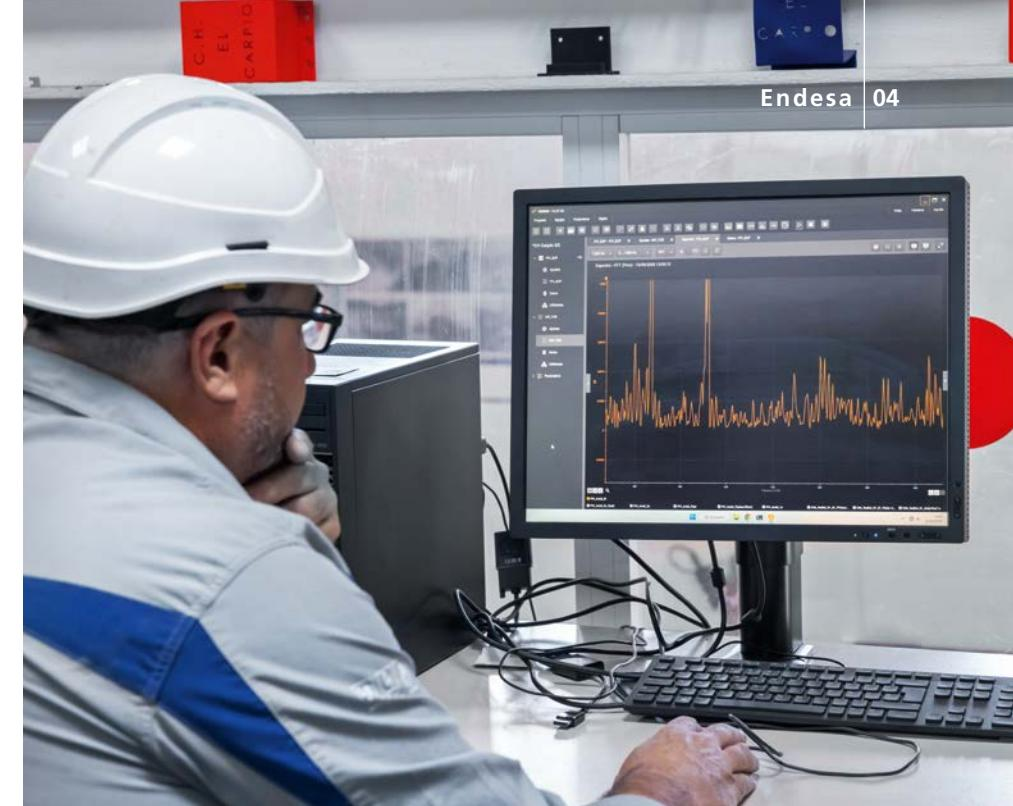
*Los datos de los sensores de vibración se evalúan en el nivel de IT. Esto permite optimizar las intervenciones de los operarios de mantenimiento.*
