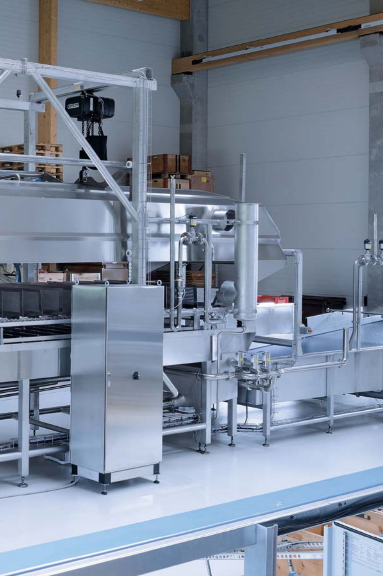
Kochanlage vom Typ staedler CK1600, gebaut von der Firma staedler automation AG. Auf dieser Anlage werden später Spätzle im Wasserbad gekocht.
