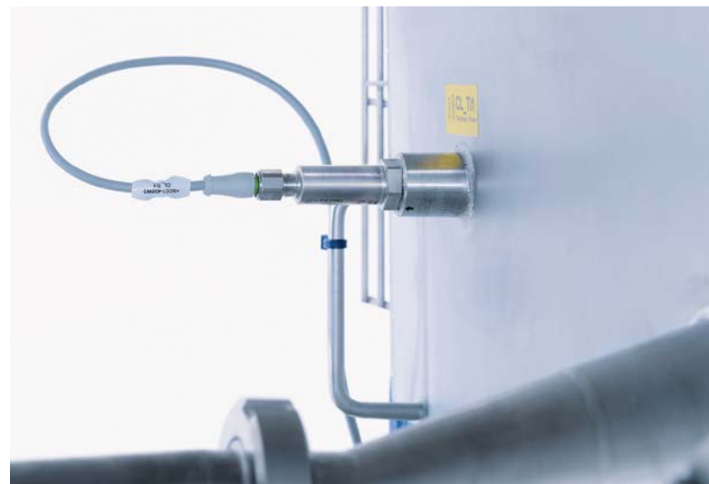
Temperatursensoren der Baureihe TA überwachen sowohl im Kochbad als auch im Abkühlbad die präzise einzuhaltenden Temperaturwerte.
