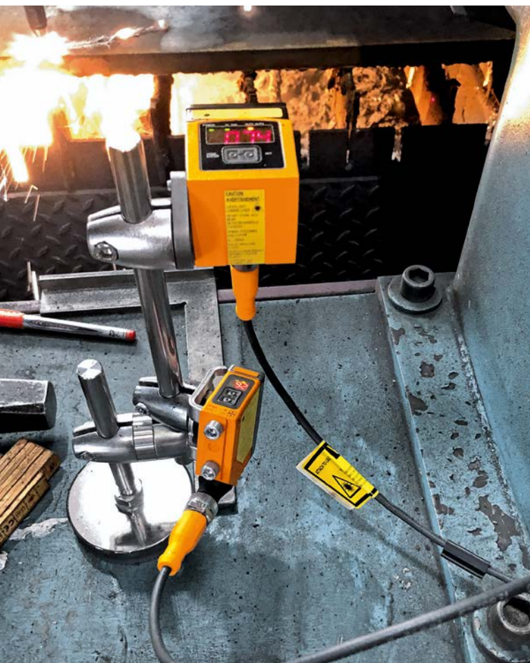
Auslastung messen: ifm-Sensoren erfassen, ob Maschinen arbeiten oder sich im Wartezustand befinden.
