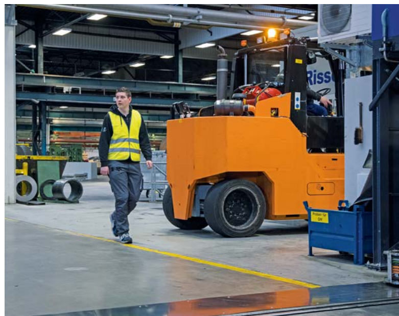
Personen hinter dem Stapler sind vom Fahrer nur schwer zu sehen. Um kritische Situationen beim Rückwärtsfahren zu vermeiden, hilft das Kollisionsschutzsystem.
