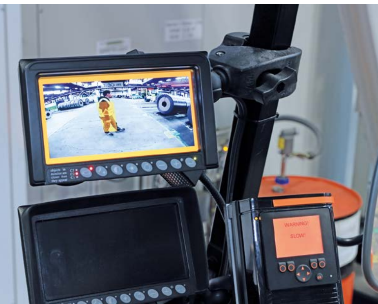
Auf dem Monitor sieht der Fahrer den Rückbereich des Staplers. Farblich abgestufte Rahmen markieren das Objekt im Fahrweg und lösen weitere Warnsignale bis hin zum Not-Stopp aus.
