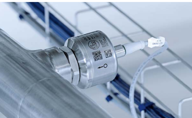
Der Leitfähigkeitssensor LDL200 erkennt zuverlässig, ob sich klares Wasser oder Reinigungsflüssigkeit vom CIP-Prozess in den Rohren befindet. Gleichzeitig misst er auch die Temperatur und überträgt beide Messwerte per IO-Link an die Anlagensteuerung.
