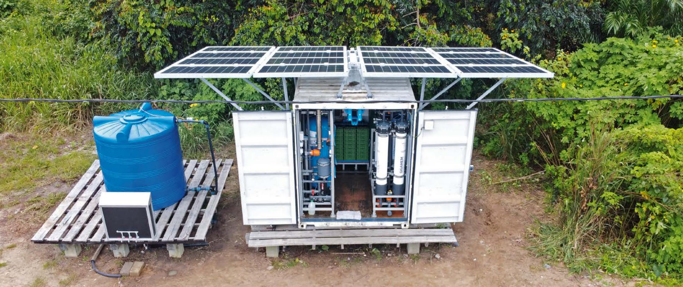
Com painéis solares no teto, a instalação é independente do fornecimento de energia e pode ser colocada diretamente onde a água é necessária.
