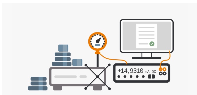
Étalonnage d'appareils de mesure de pression au moyen de balances de pression
