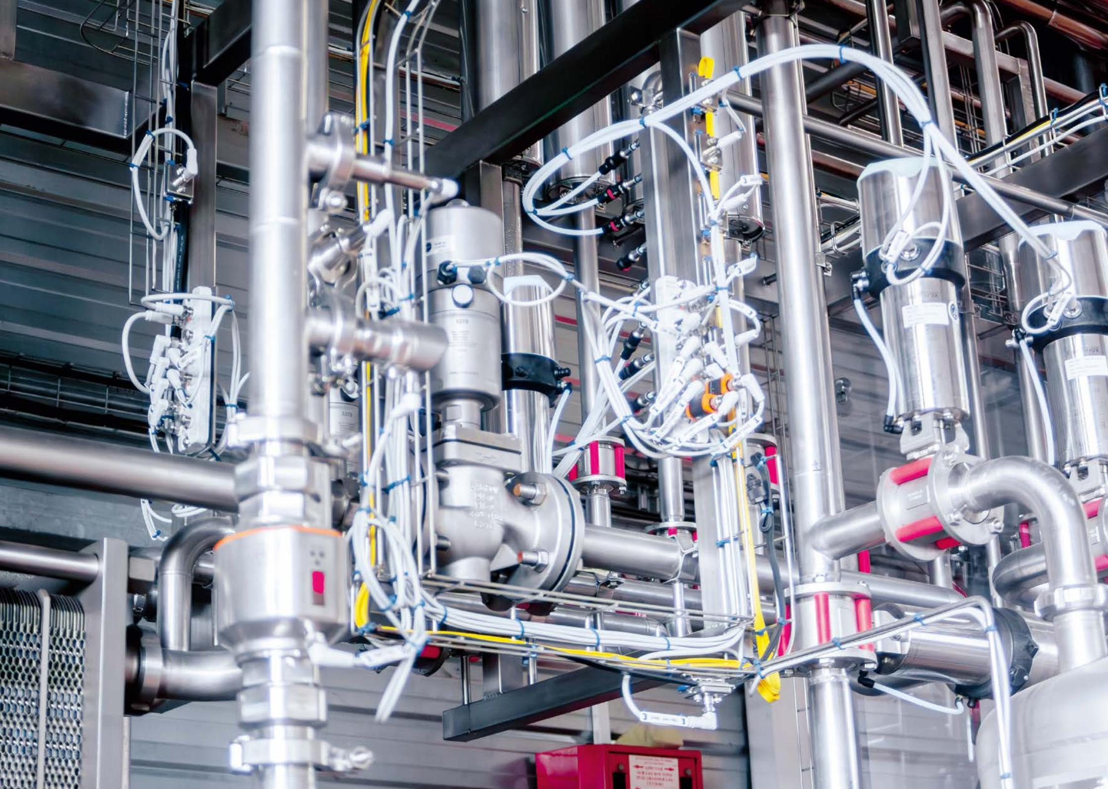
*AS-i trifft IO-Link: Beide digitalen Kommunikationstechnologien lassen sich ideal miteinander vernetzen, sodass sich die Vorzüge auch kombiniert nutzen lassen. Hier werden unter anderem Durchfluss, Druck und Temperatur via IO-Link an AS-i übermittelt.*
