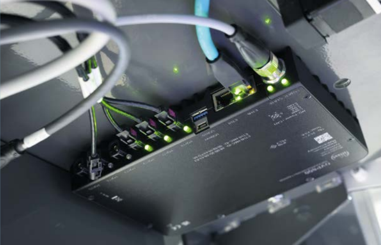
視訊處理單元是 O3R 系統的中央組件。 該單元可連結多達 6 台攝像頭。
