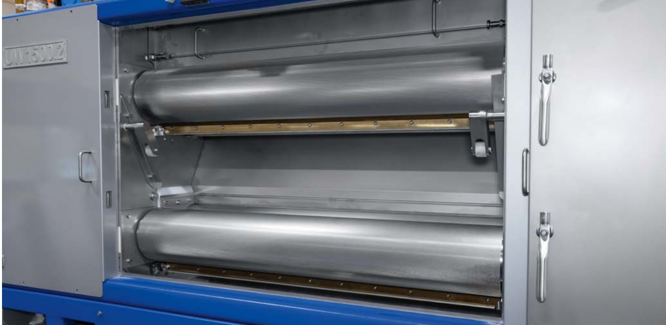
Mühlstein war früher: Edelstahlwalzen eines 2-stufigen Mahlwerks.
