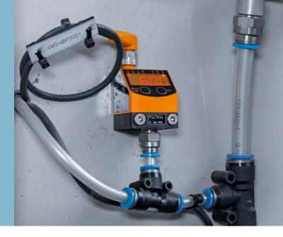
Un sensor de presión de la gama PQ controla el aire comprimido necesario para activar las válvulas.
