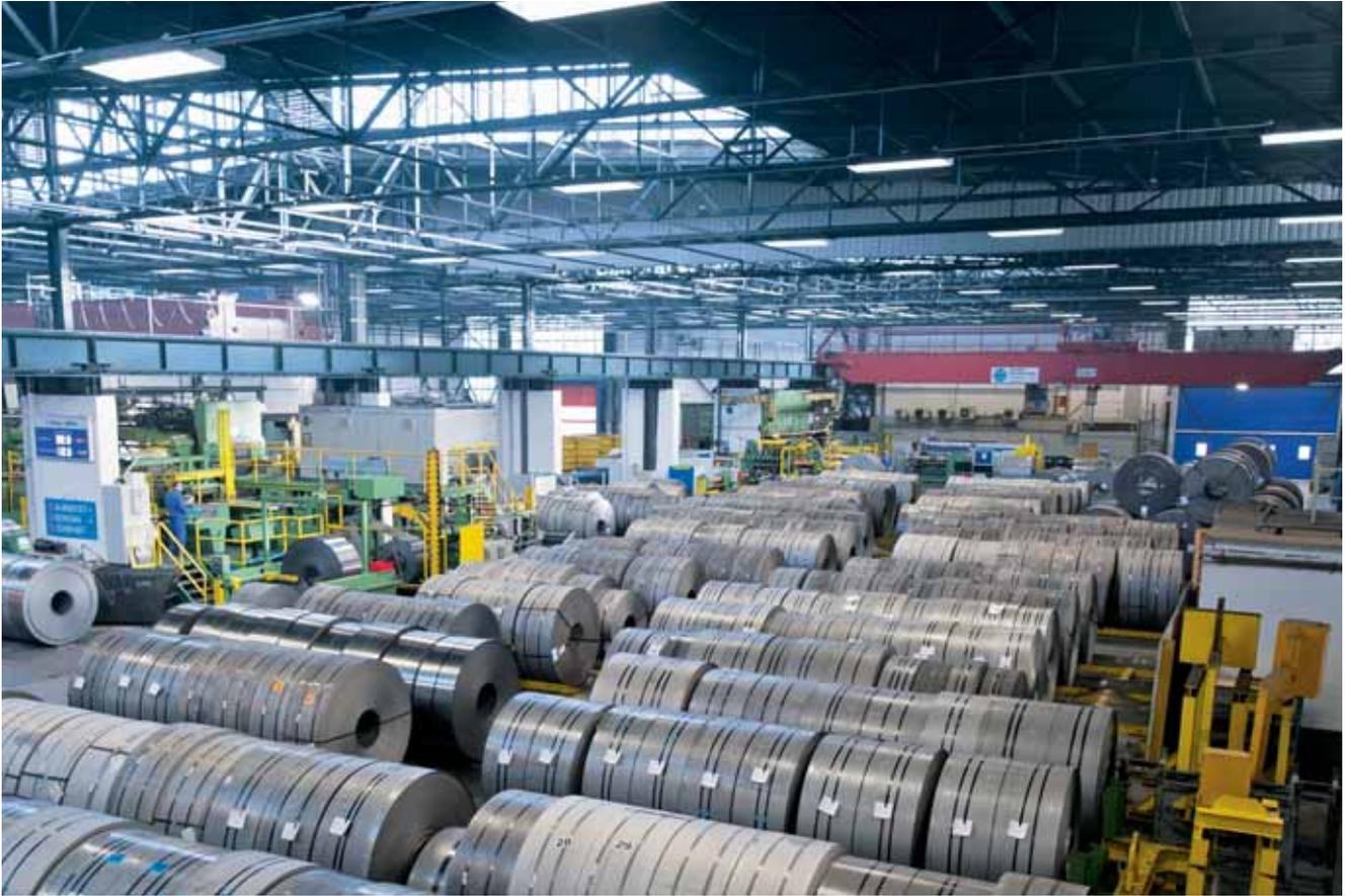
在冷轧机中，钢板通常以钢卷的形式提供，然后通过轧制材料缩小为所需厚度。首先除去起始材料（通常是热轧宽带钢）的锈皮，然后以轧制工艺减少横截面。达到最终厚度时，钢板将被切为所需宽度，然后包装并发货。除了其他之外，此类产品的市场是汽车行业/供应商、管道供应商和白色家用电器。
