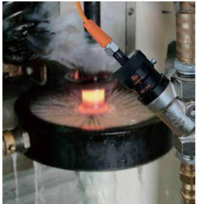
机械电子传感器在感应炉的冷却剂回路中
