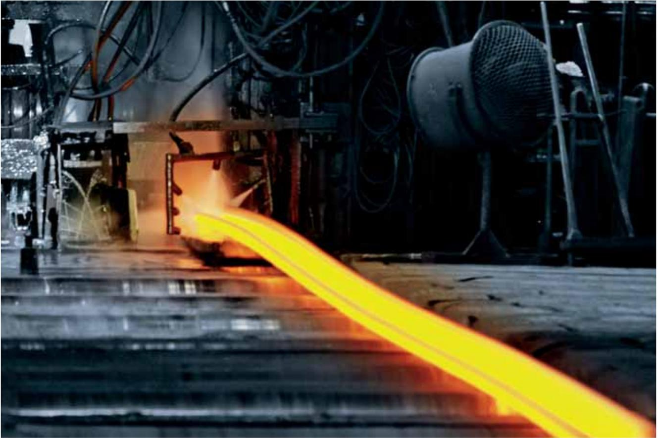
在热轧机板坯中，钢厂生产的块料或坯料被进一步处理。为此，材料会被加热至超过再结晶所需的温度。根据开始材料的不同，使用热轧机加工长钢产品（如电线、铁轨或钢梁）或宽带钢产品（如金属板）。然后，通过后续工艺对这些半成品进行进一步加工。与其他行业相比，高温和恶劣的环境条件导致所使用的传感器必须满足更高的要求。易福门提供扩展温度范围的坚固传感器检测相关参数，即使对于这些非常恶劣的条件。这里，易福门传感器能确保在极端环境影响下的设备长期正常稳定运行。
