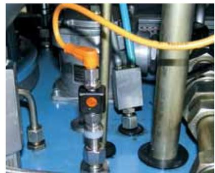
使用模块化TP变送器而不是常用的头/DIN导轨变送器。
