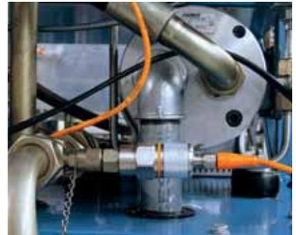
长期稳定模拟值确保可靠监控液压力装置。
