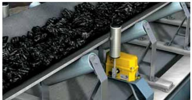
绳开关和皮带漂移开关的安装
