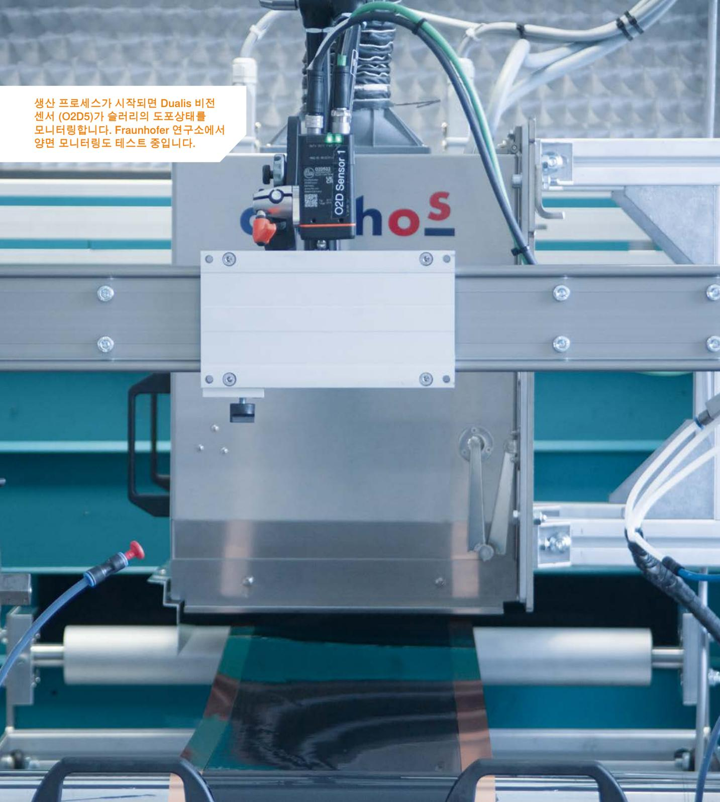
생산 프로세스가 시작되면 Dualis 비전 센서 (O2D5)가 슬러리의 도포상태를 모니터링합니다. Fraunhofer 연구소에서 양면 모니터링도 테스트 중입니다.
