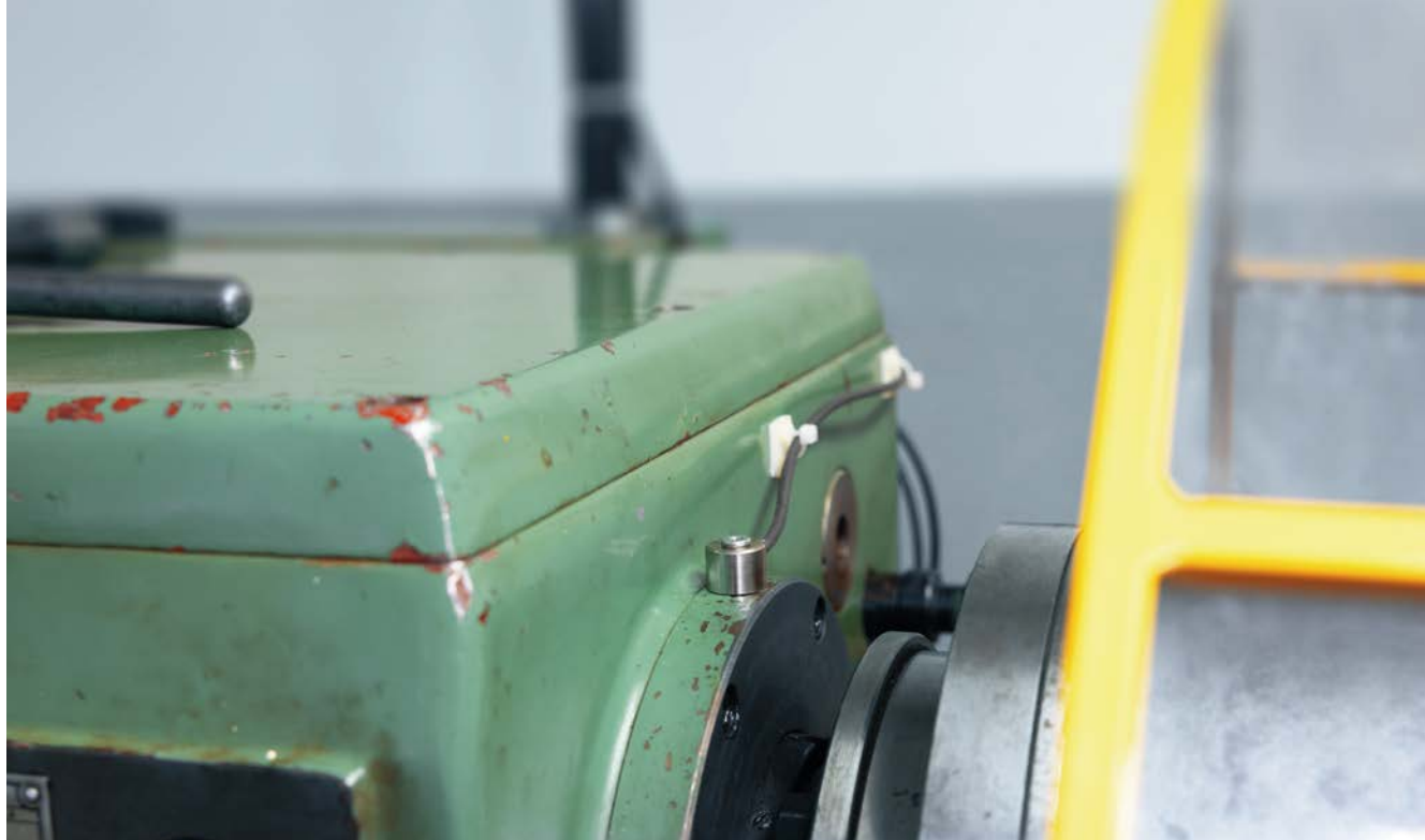
機械の「耳」：振動センサVSA005で、機械の駆動部のすべてのベアリングの振動スペクトルを検出します。
