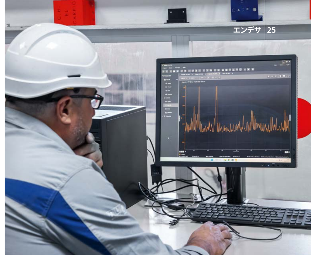
振動センサのデータをITレベルで分析。 計画的なメンテナンスの最適化を実現。
