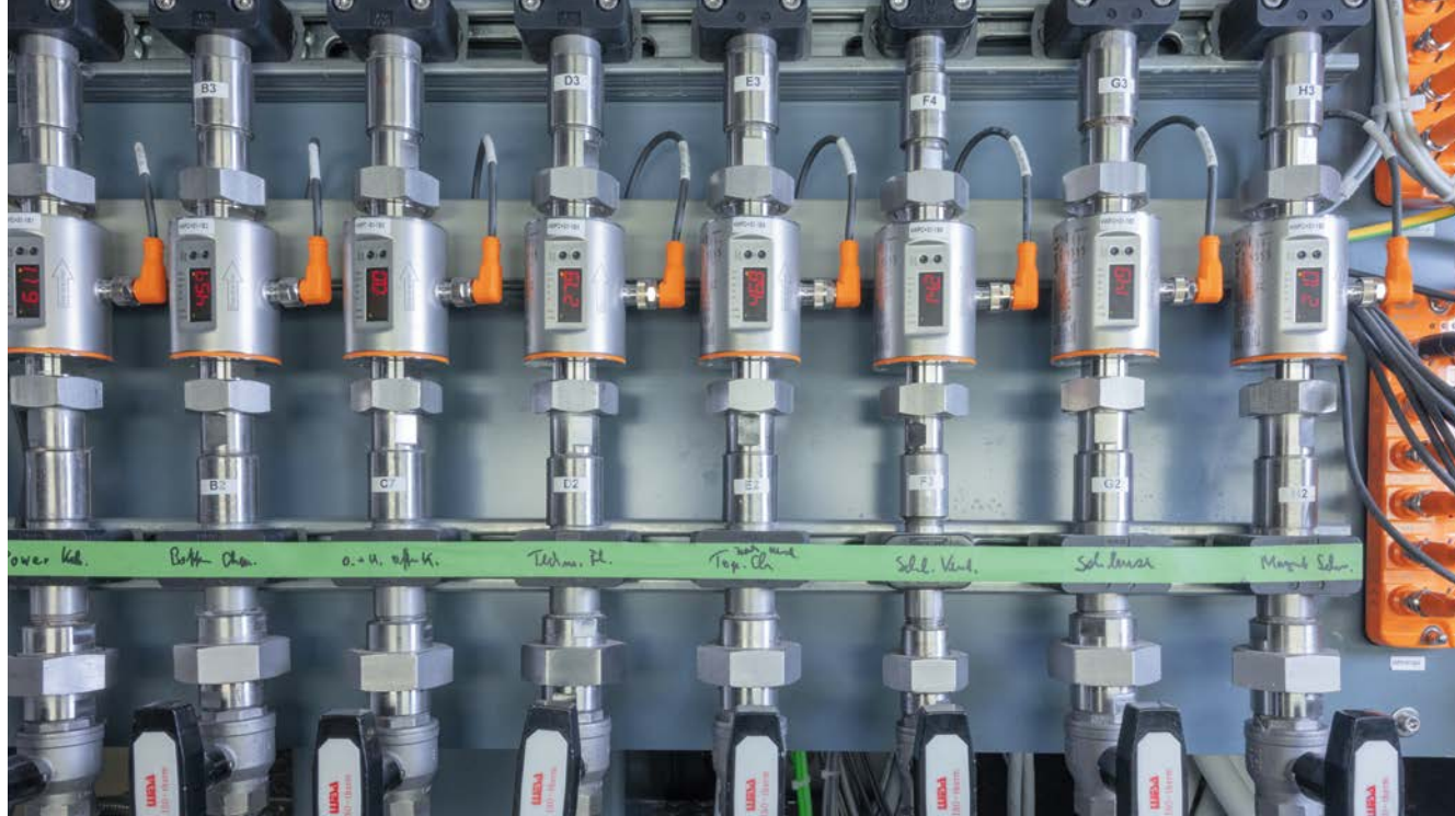
CZ結晶成長装置の冷却回路を監視する流量センサ。
