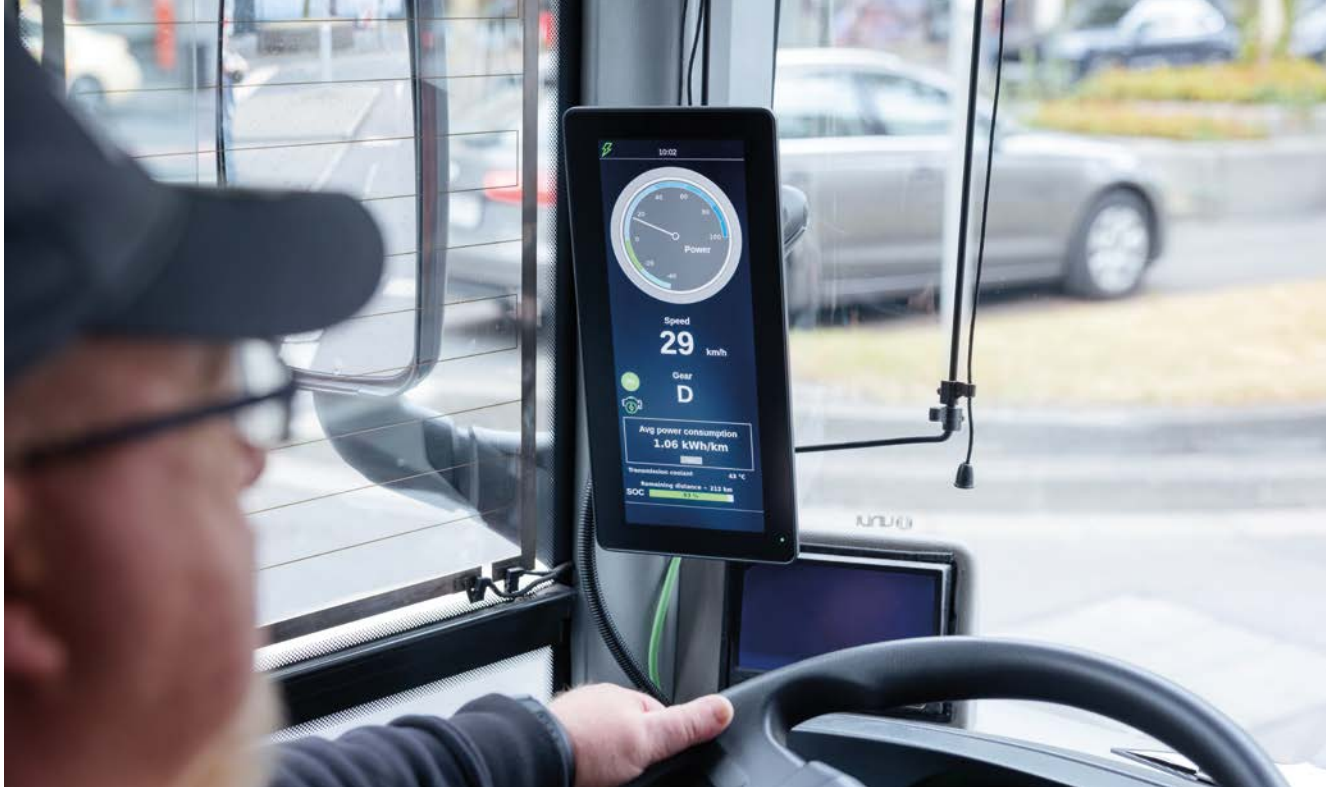
EV駆動系の主要パラメータを表示する HMIディスプレイCR1203。
