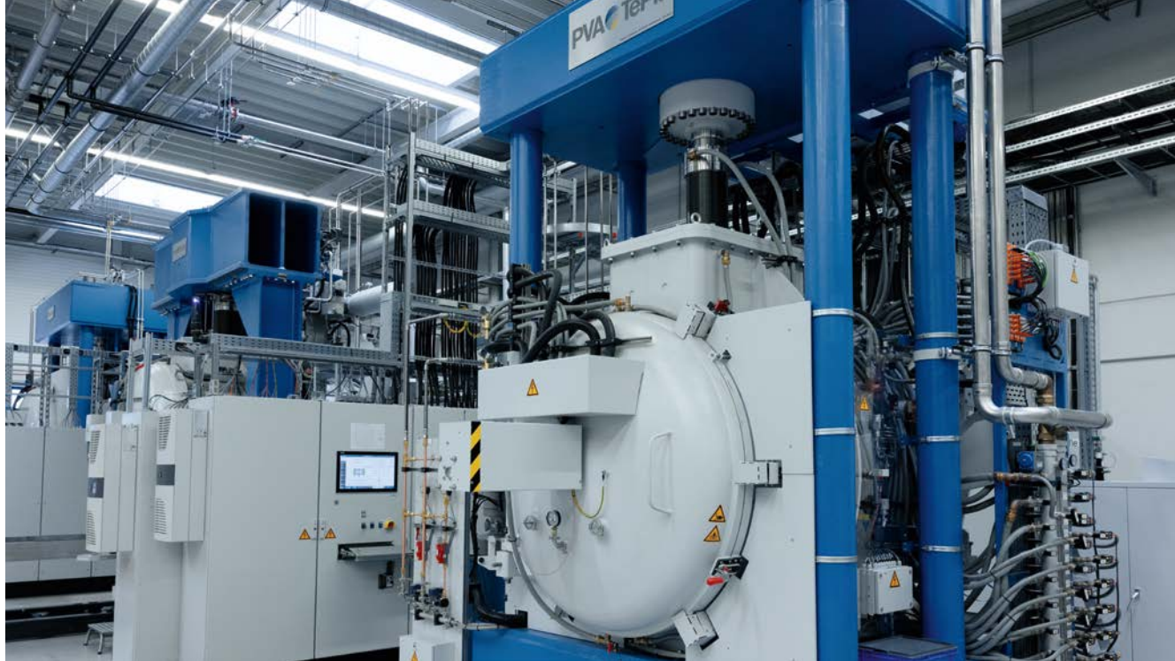
高圧で各層を接合する拡散接合炉。
