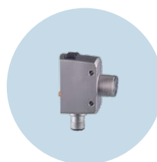
Sensor óptico de distância OGD Detecção precisa de objetos por meio da medição do tempo de voo da luz
