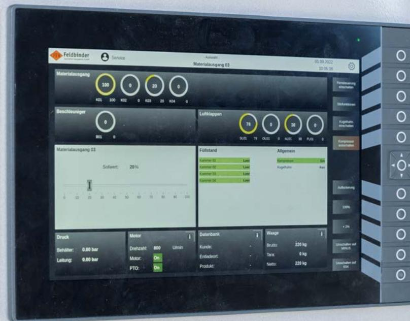
O ecomatDisplay com tela tátil capacitiva de 12 polegadas e botões livremente configuráveis está projetado para o uso móvel na cabine e no ambiente exterior. Há um sistema de comando potente integrado que pode ser programado individualmente com CODESYS. Com o ecomatPanel, a empresa Feldbinder complementa a tela.
