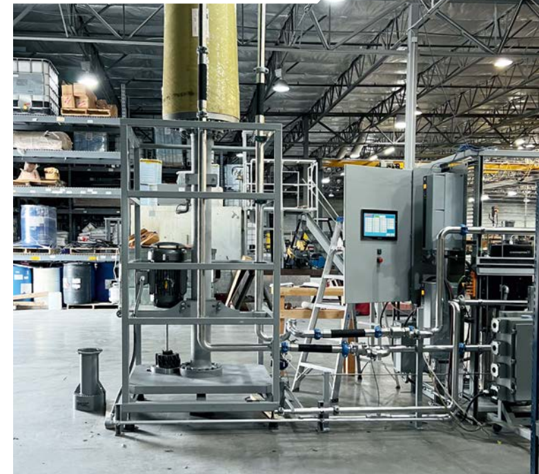
전체 시스템의 핵심: 멤브레인에서 진동 작용을 일으키는 20 hp 모터가 함께 작동하는 필터링 시스템
