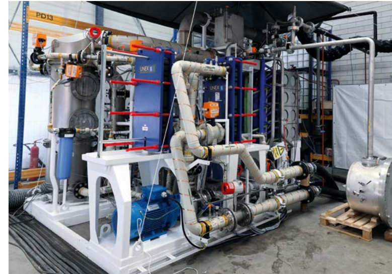
Koedood와 Kooiman이 개발한 K2 수소 발전기는 설치 전 테스트를 거칩니다.
