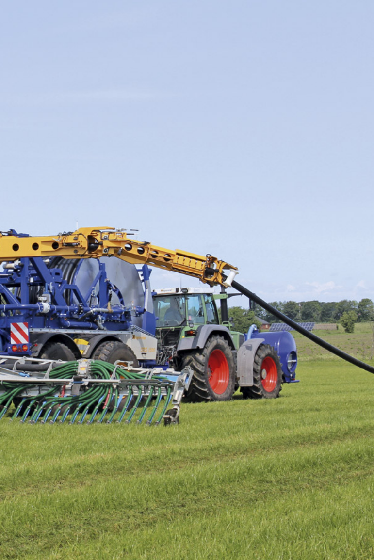
O enrolador de mangueira SRS 1500 é puxado pelo campo por um trator para espalhar o chorume.
