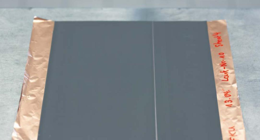
Les zones non enduites lors de l'apposition de la pâte engendrent une mise au rebut et doivent absolument être identifiées. Le capteur de vision Dualis d'ifm signale cette erreur et aide à minimiser le taux de rebut.
