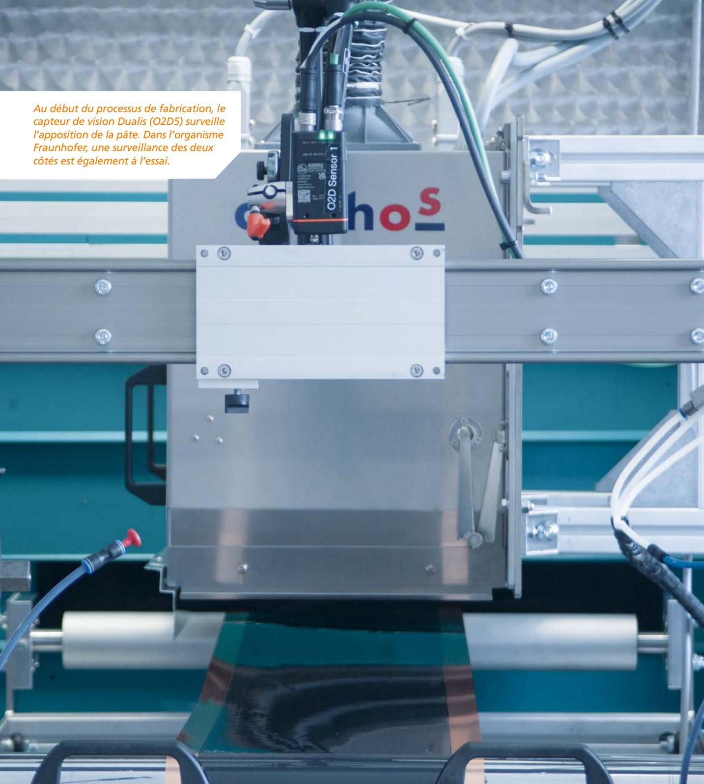
Au début du processus de fabrication, le capteur de vision Dualis (O2D5) surveille l'apposition de la pâte. Dans l'organisme Fraunhofer, une surveillance des deux côtés est également à l'essai.
