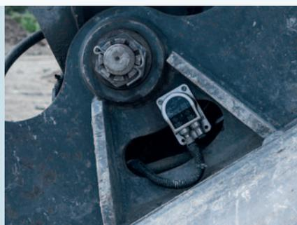
*Capteurs d'inclinaison dynamiques version JD Pour applications sur engins mobiles.*
