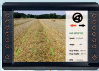
Caméra O2M avec sortie vidéo analogique
