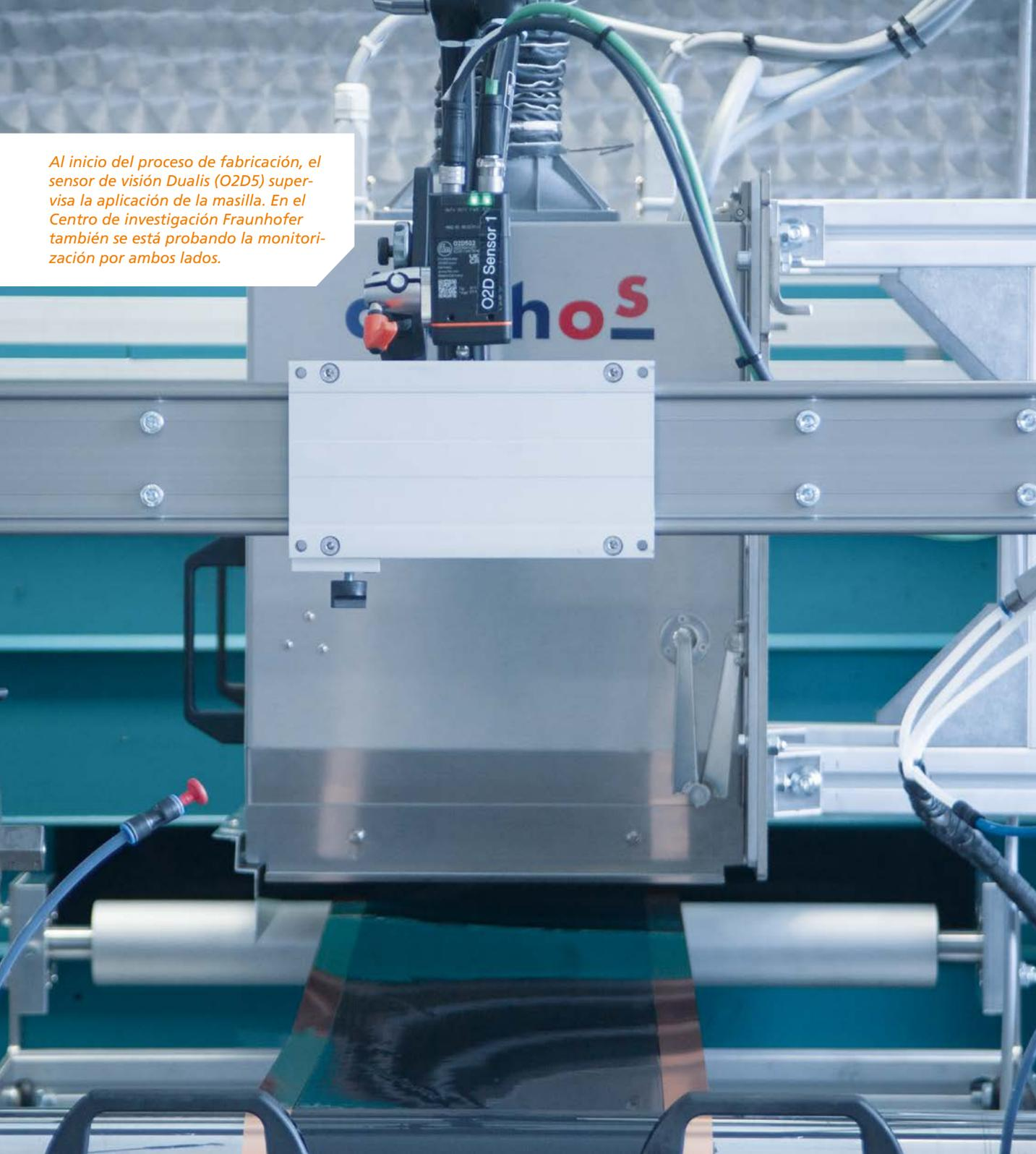
Al inicio del proceso de fabricación, el sensor de visión Dualis (O2D5) supervisa la aplicación de la masilla. En el Centro de investigación Fraunhofer también se está probando la monitorización por ambos lados.
