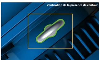
L'assistant « contrôle de présence de contours » vous aide à mettre en place une solution pour le simple contrôle de présence d'un contour. Même un utilisateur inexpérimenté peut configurer l'application en 2 minutes.
