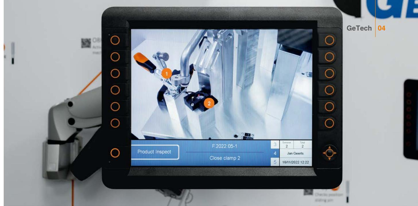
또 다른 중요한 센서 시스템은 실제 윤곽을 감지하여 테스트 프로그램에 정의된 타겟 윤곽과 비교하는 O2D 윤곽 센서입니다. 허용오차 한계를 벗어난 값은 결함으로 인식됩니다.
