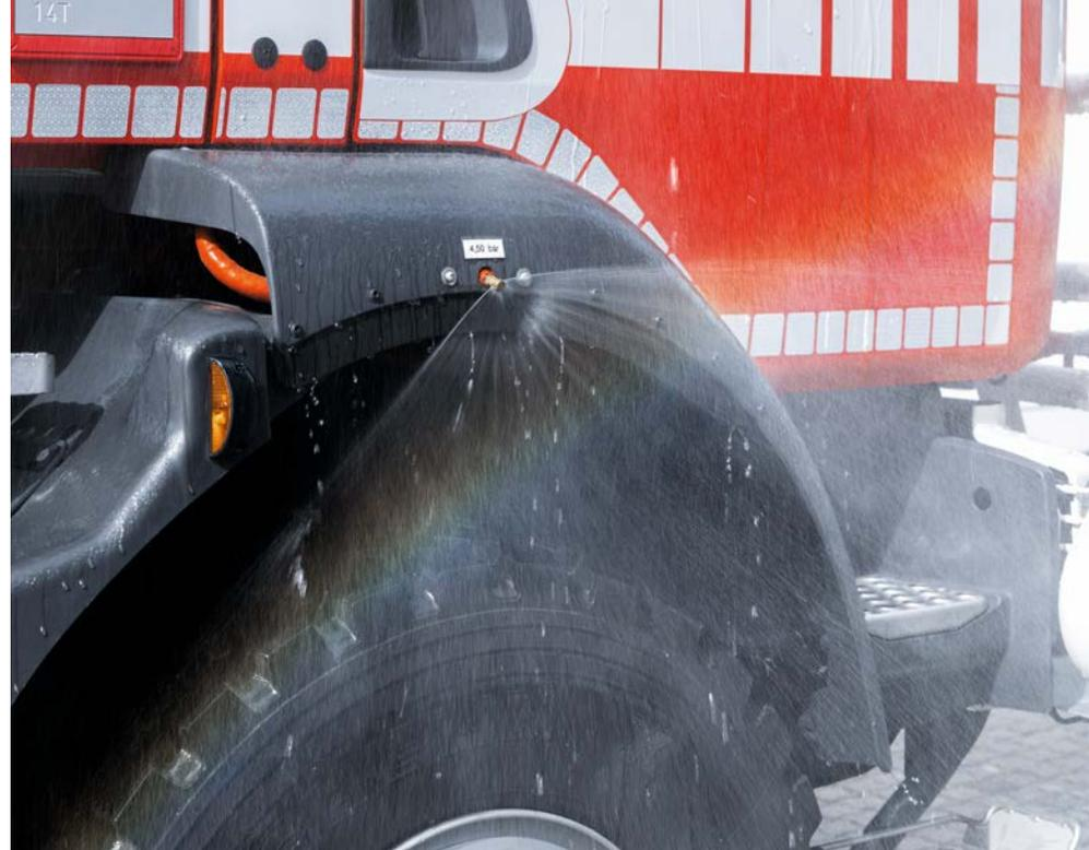
*Le système d'autoprotection pulvérise de l'eau sur les vitres et les pneus. En cas d'urgence, cela permet au véhicule d'échapper aux murs de feu, en passant à travers les flammes.*
