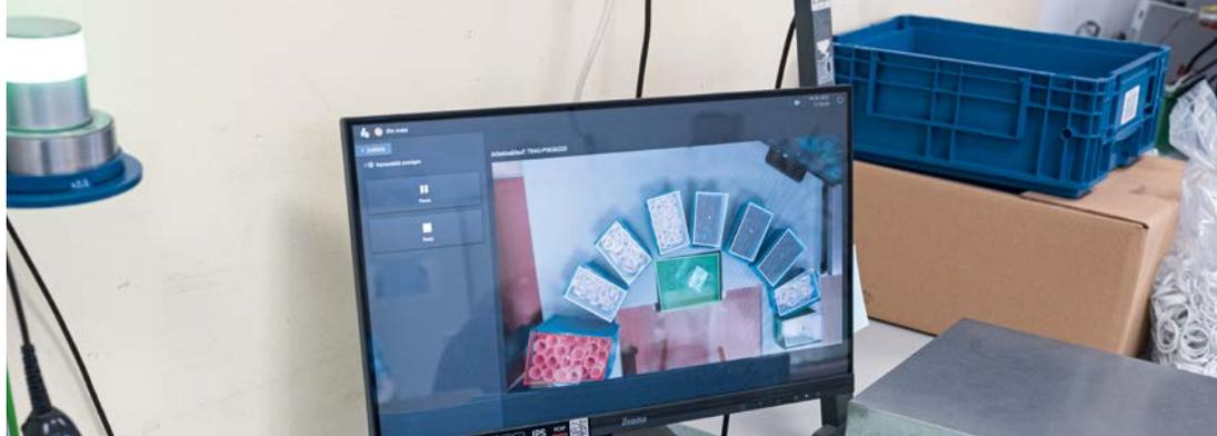
*Si de nombreuses pièces détachées, parfois identiques, doivent être emballées correctement, des erreurs peuvent rapidement survenir. Le système d'assistance ifm mate aide efficacement à les éviter.*
