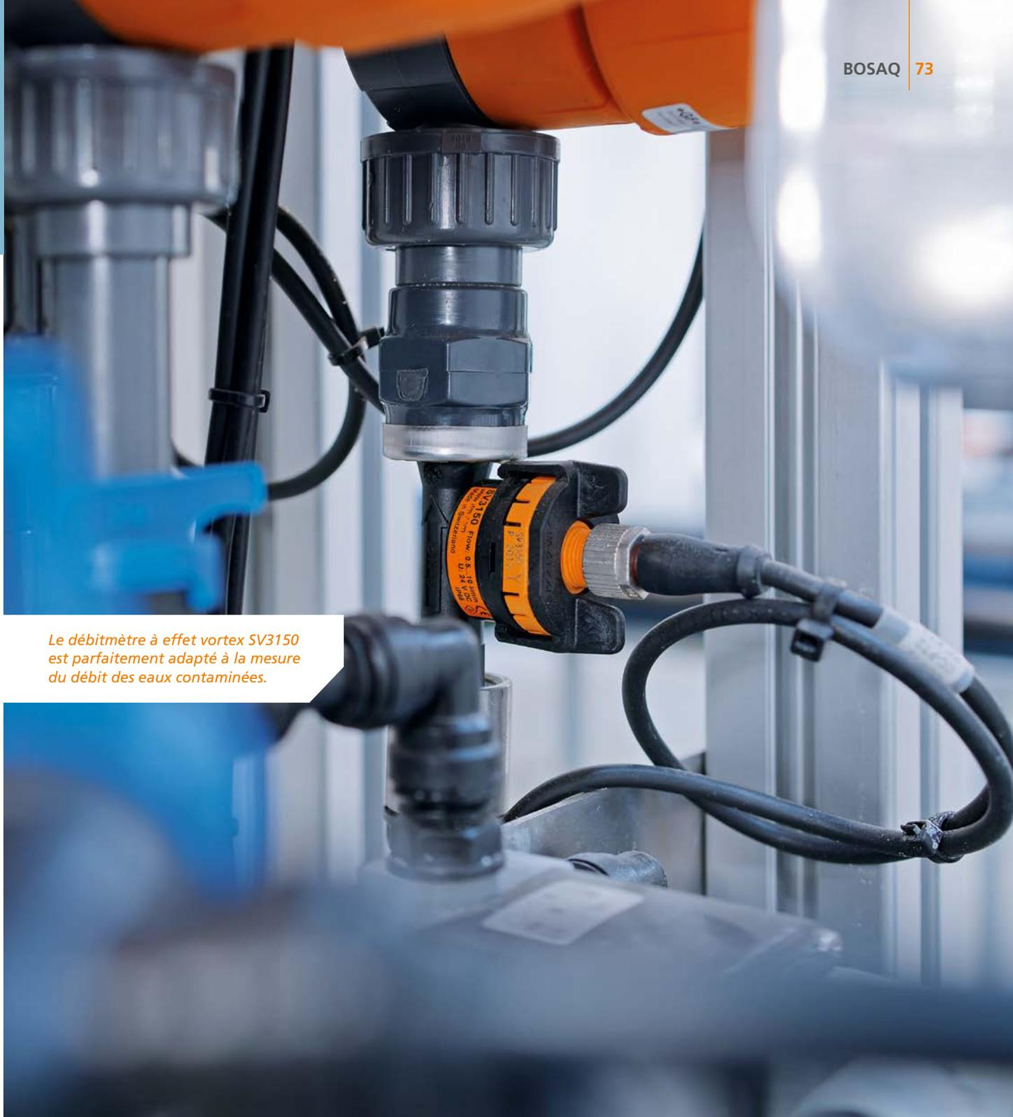
Le débitmètre à effet vortex SV3150 est parfaitement adapté à la mesure du débit des eaux contaminées.
