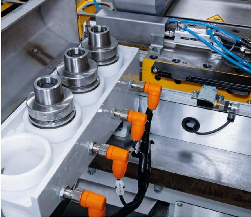
*Des détecteurs inductifs détectent la présence des têtes de fraisage (à gauche), un détecteur reflex assure le positionnement exact des pièces avant le soudage et un codeur multi-tours absolu est utilisé pour la mesure précise de la longueur (en bas) : pour toutes ces tâches, Kettec mise sur les technologies de détection d'ifm.*
