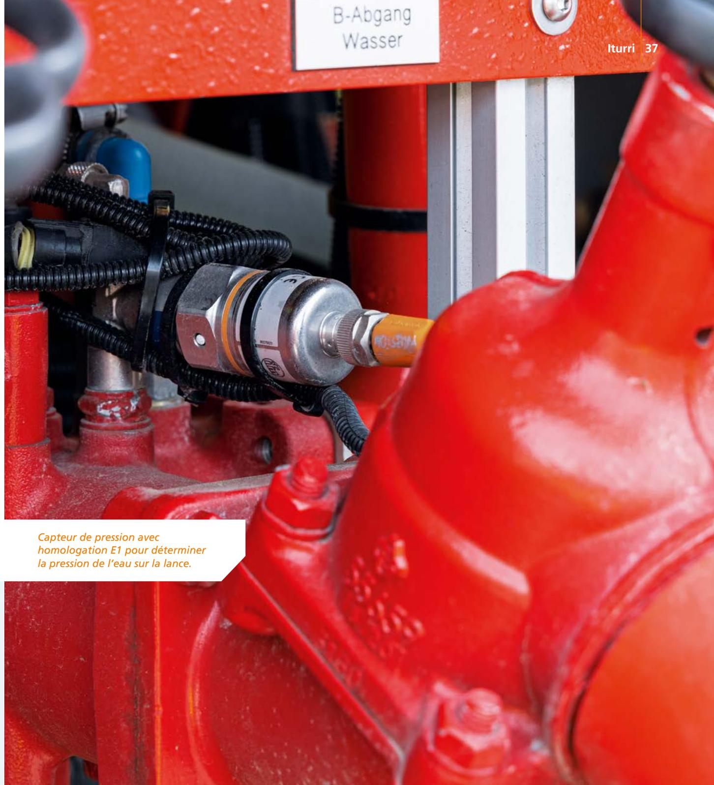
Capteur de pression avec homologation E1 pour déterminer la pression de l'eau sur la lance.
