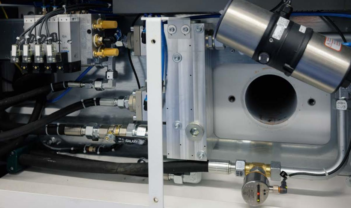
*Der Strömungswächter erfasst die Geschwindigkeit, mit der die Kühlflüssigkeit dem Schleifprozess zugeführt wird. Der LED-Bargraph zeigt das Strömungsverhalten an.*
