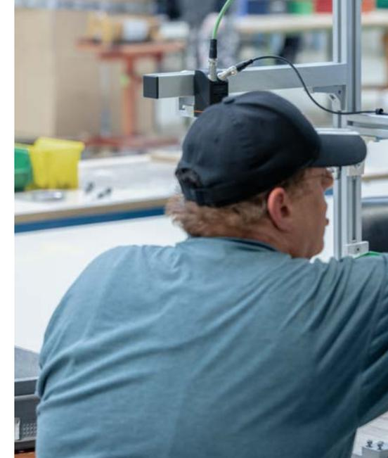
são comparadas com o processo de trabalho manual armazenado. O sistema guia o usuário passo a passo pelo processo de produção e o apoia com instruções visuais em uma tela. Ao contrário de outros sistemas no mercado, o ifm mate não requer nenhum auxílio adicional, como pulseiras de rastreamento, graças ao seu confiável reconhecimento de mãos.
