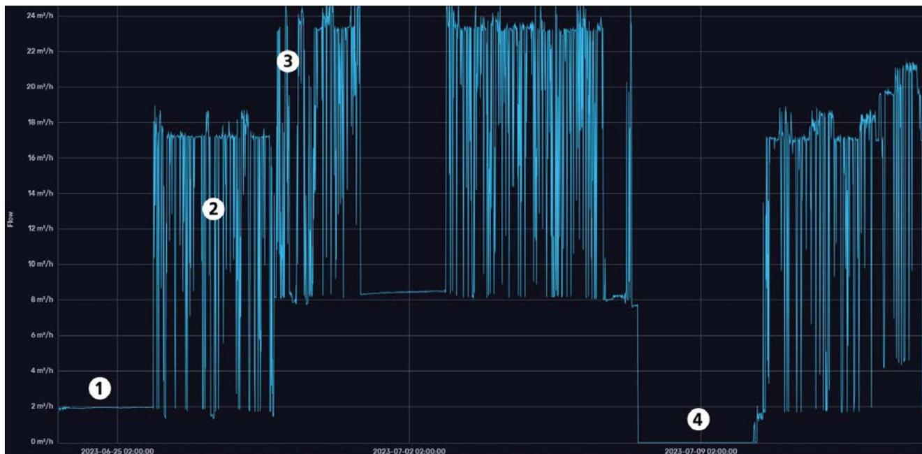
Información valiosa sobre la red de aire comprimido. Claramente reconocible: el consumo básico (1) y el consumo de producción (2) aumentan significativamente después de la aparición de la fuga (3). Una vez solucionada la fuga, el consumo básico desciende hasta casi cero (4).
