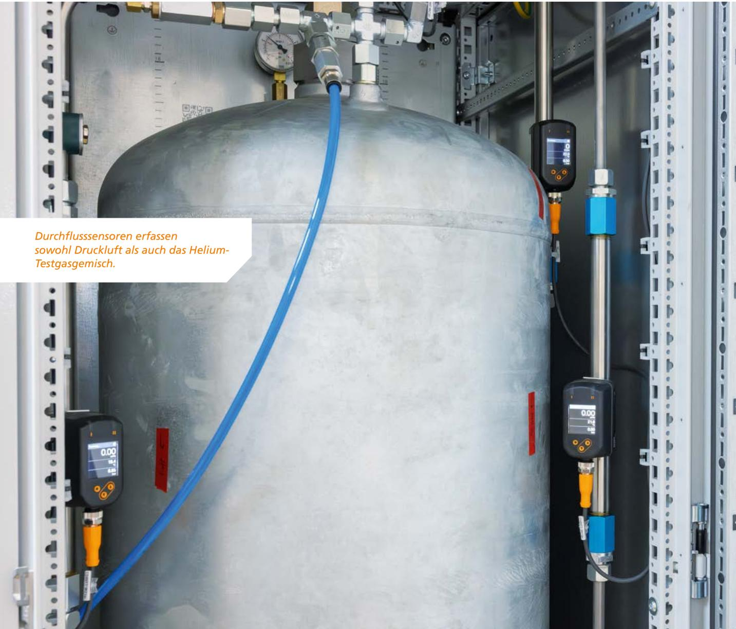
Durchflusssensoren erfassen sowohl Druckluft als auch das Helium-Testgasgemisch.
