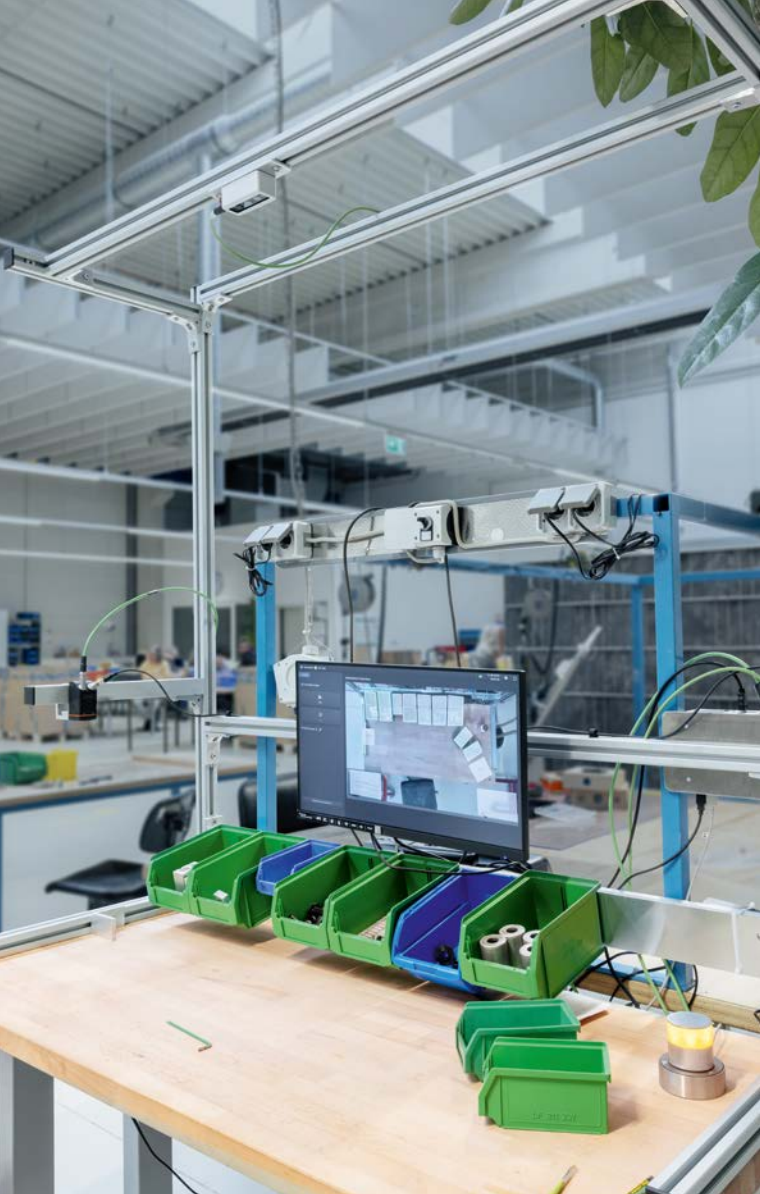
ifm mate comme solution complète : la caméra (au-dessus du poste de travail), le logiciel et l'ordinateur peuvent être complétés aisément par un écran tactile, une lampe de signalisation (en bas à droite sur la photo) et le capteur de vision O2D5 (bord gauche de la photo, monté sur la traverse).
