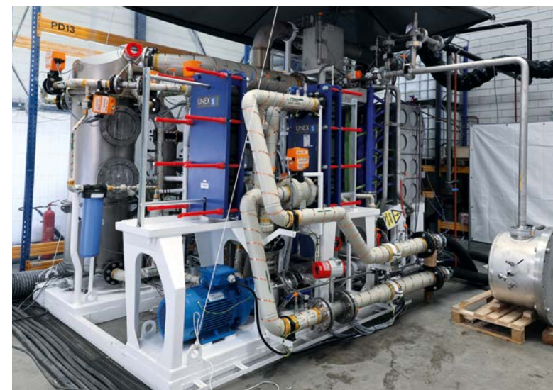
Koedood和Kooiman开发的K2氢气发生器在安装前进行测试。
