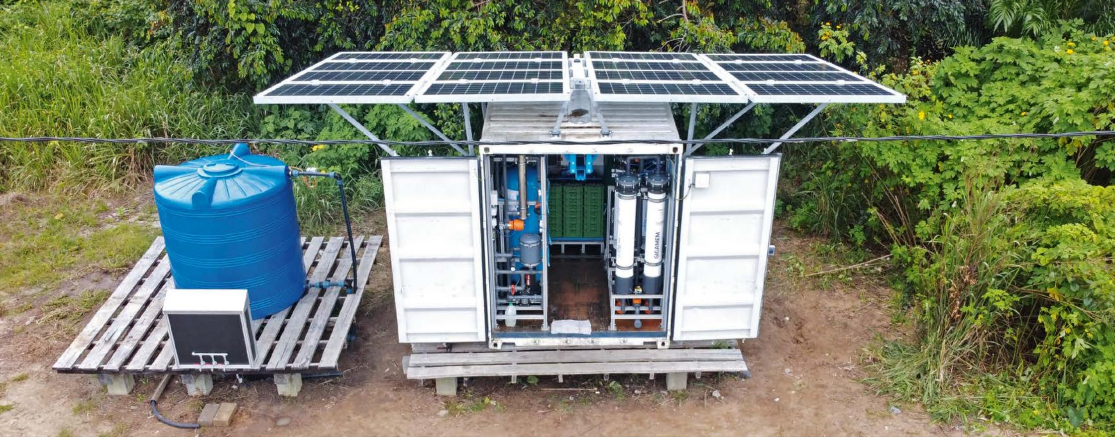
Mit Solarpanelen auf dem Dach ist die Anlage unabhängig von der Energieversorgung und kann direkt da aufgestellt werden, wo das Wasser benötigt wird.
