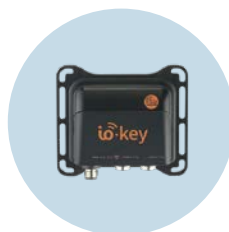
io-key Envio de dados do sensor para a nuvem através da rede móvel
