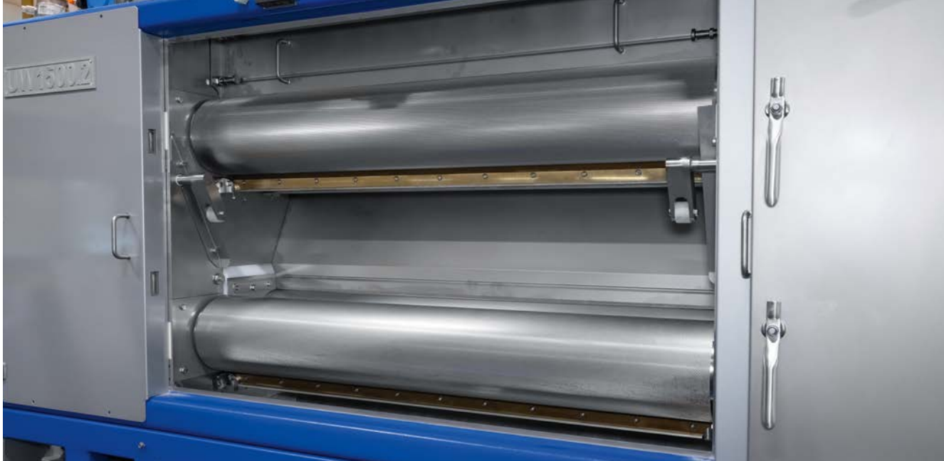
La meule en pierre, c'était hier : ci-contre, les cylindres en inox d'un broyeur à deux étages
