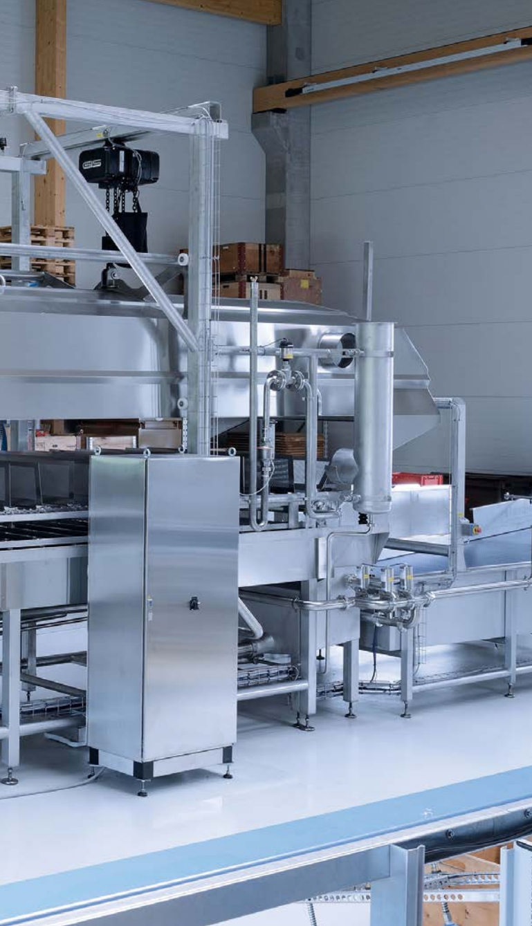
烹饪系统型号CK1600，由staedler automation AG制造。该系统将用于烹饪面疙瘩。
