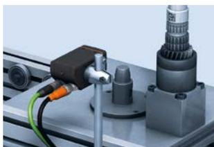
**Description :** L'O2I5 identifie l'arbre de transmission à l'aide d'un code micro percuté unique sur le produit. Celui-ci est ensuite transmis à l'automate via PROFINET.
