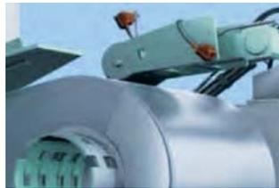
**Description :** Les détecteurs PMD O1D surveillent le mouvement correct de la bande d'acier et le déroulement de la bobine.
