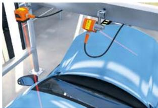
**Description :** Quand une carrosserie arrive à une position définie avec le capot ouvert, le faisceau est interrompu et une validation est donnée.
