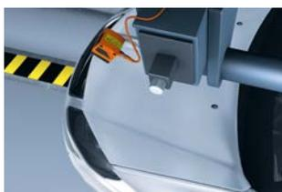
**Description :** La carrosserie est montée dans une étape ultérieure. Le détecteur de distance optoélectronique O1D empêche toute collision avec une autre carrosserie.
