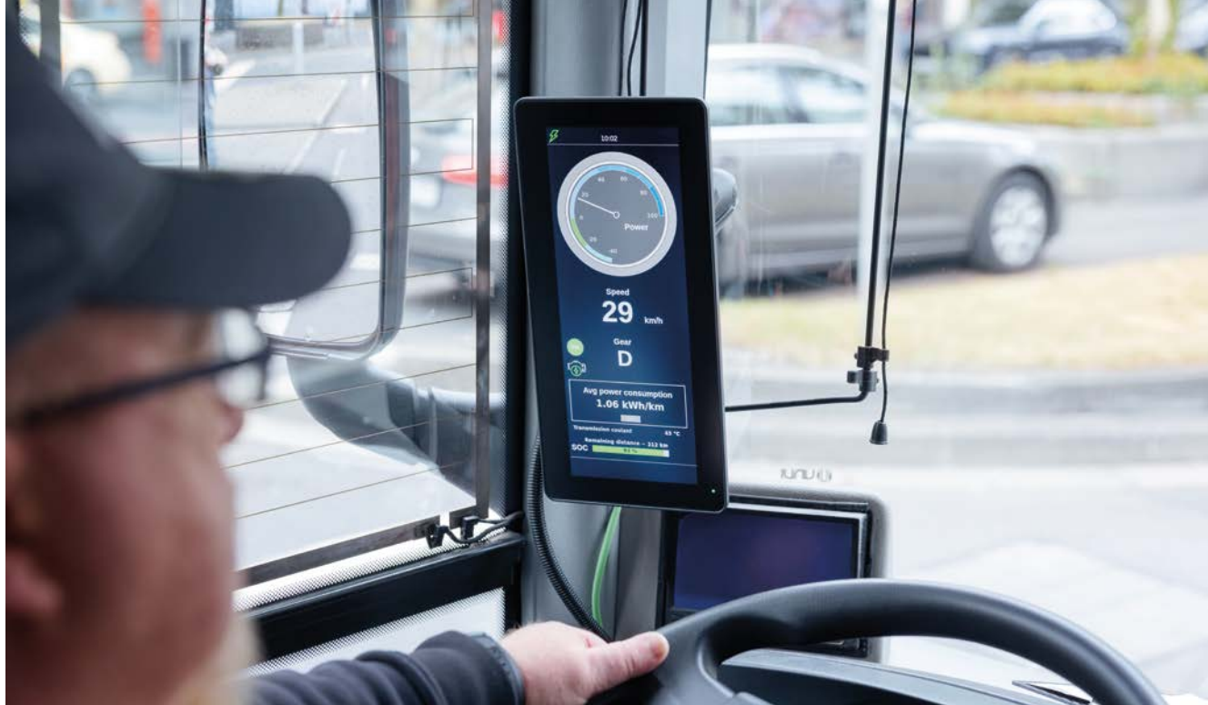
Im Cockpit informiert das robuste Grafikdisplay CR1203 den Fahrer über alle wichtigen Parameter des elektrischen Antriebssystems.
