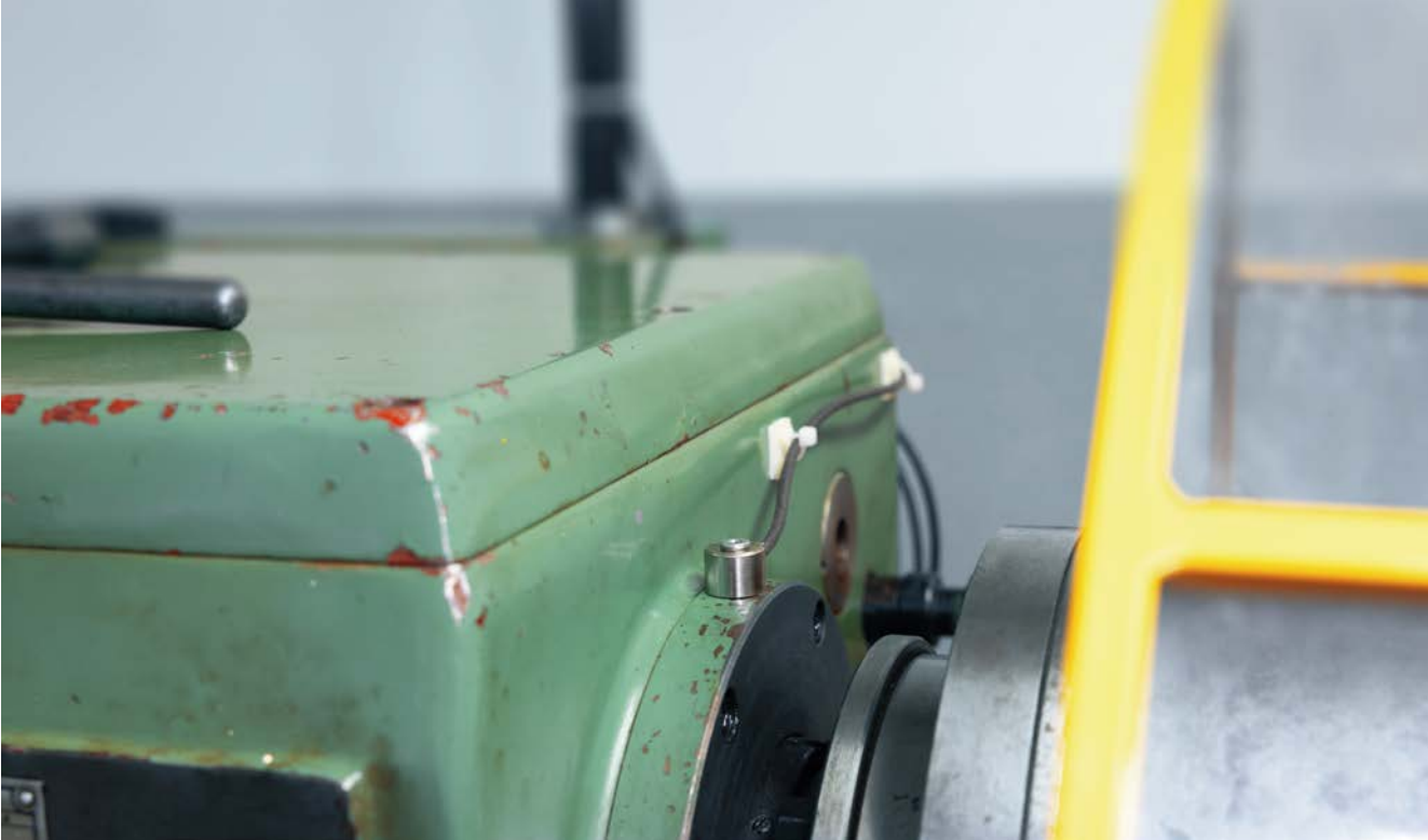
El "oído" de la máquina: el sensor de vibraciones VSA005 registra los espectros de vibración de todos los rodamientos del accionamiento de la máquina.
