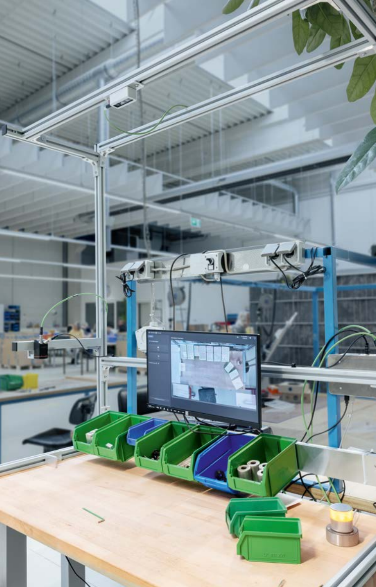
総合的なソリューションのifm mate:画面タッチ操作で簡単に拡張できるカメラ(作業台上)・ソフトウェア・PCとシグナルランプ(右下)・O2D5形状認識センサ(左端バー上部)
