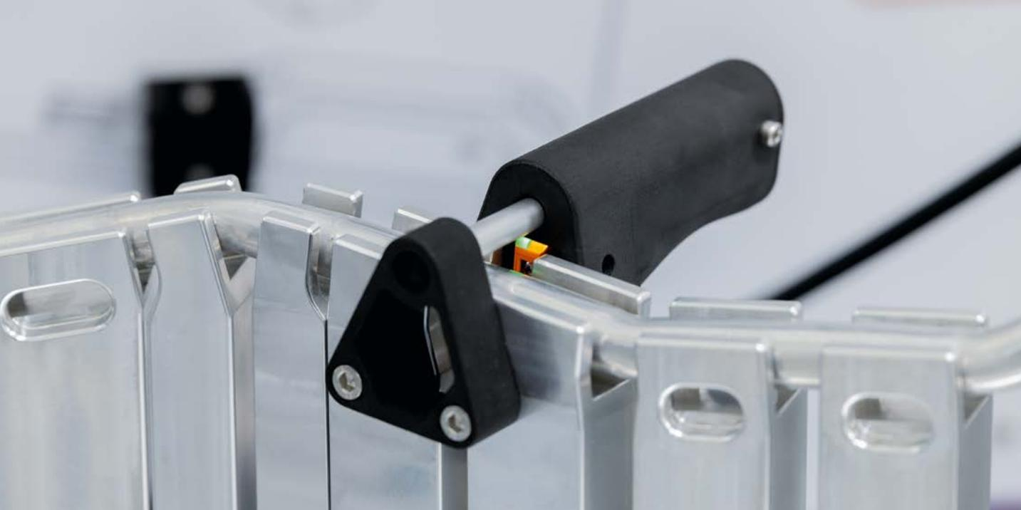
*Einer von mehreren optischen Sensoren erfasst, ob die Leitung in die Lehre eingelegt ist. Die Verriegelung wird erst gelöst, wenn alle Schritte der Qualitätsprüfung erfolgreich abgeschlossen sind.*
