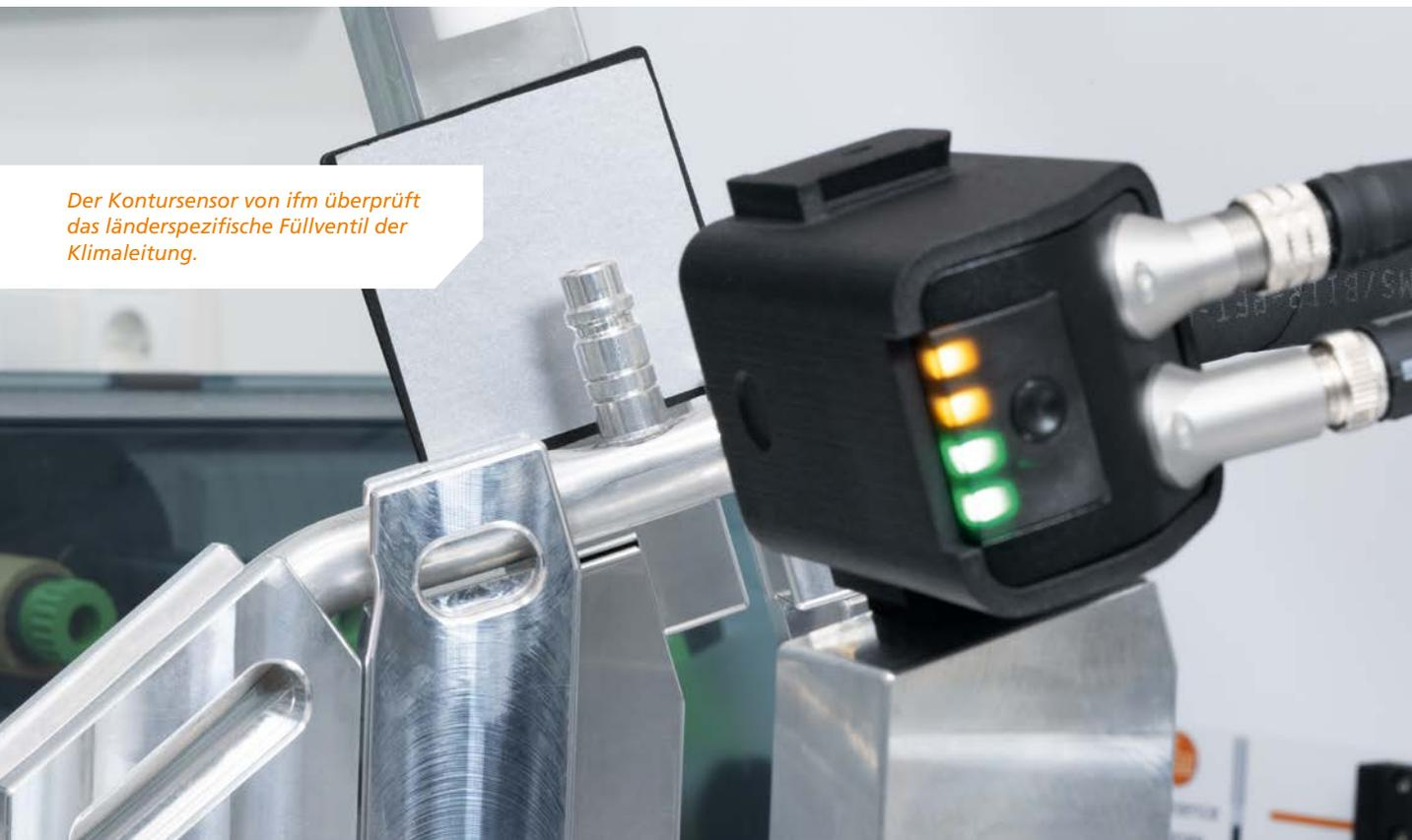
*Der Kontursensor von ifm überprüft das länderspezifische Füllventil der Klimaleitung.*
