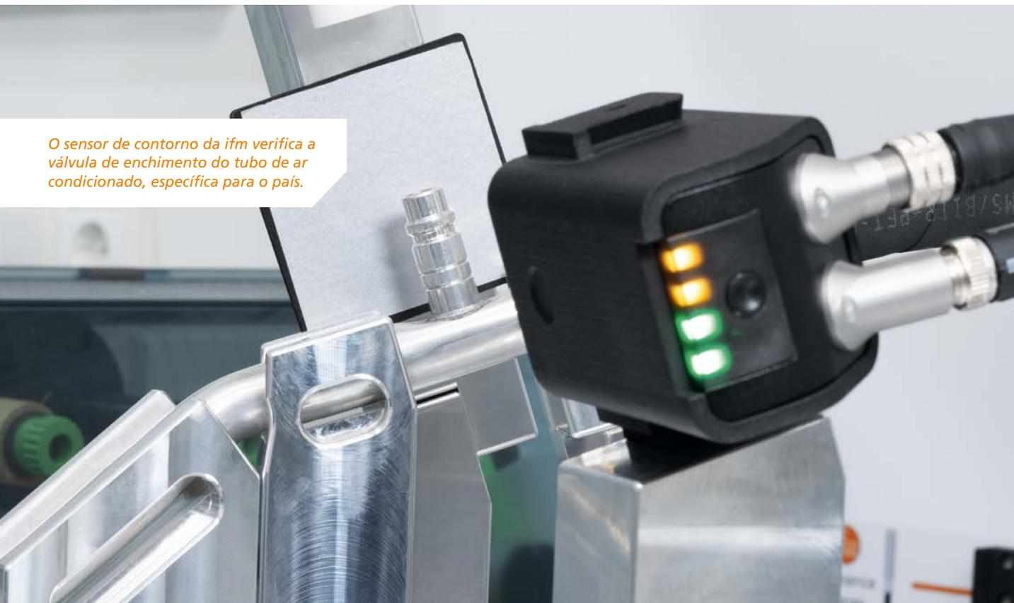
*O sensor de contorno da ifm verifica a válvula de enchimento do tubo de ar condicionado, específica para o país.*
