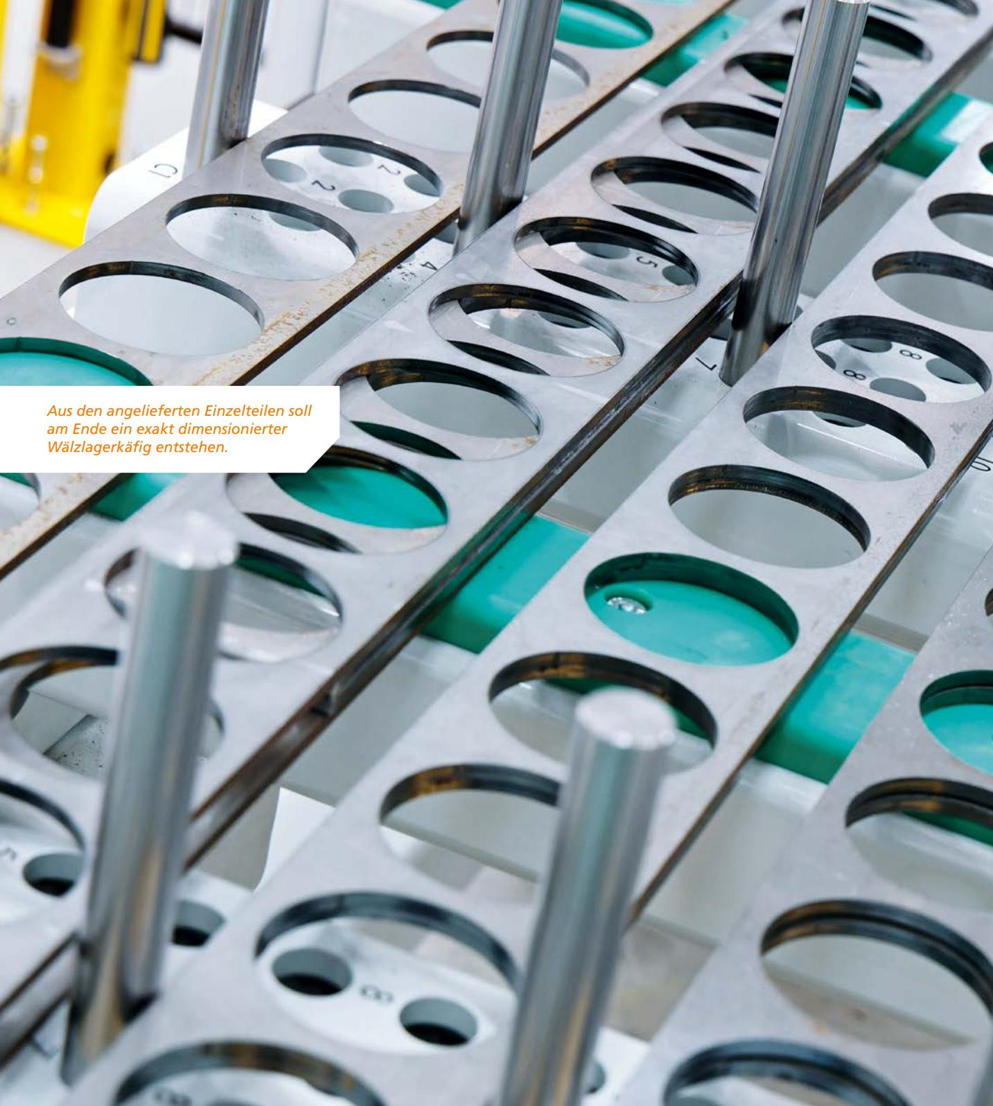
Aus den angelieferten Einzelteilen soll am Ende ein exakt dimensionierter Wälzlagerkäfig entstehen.
