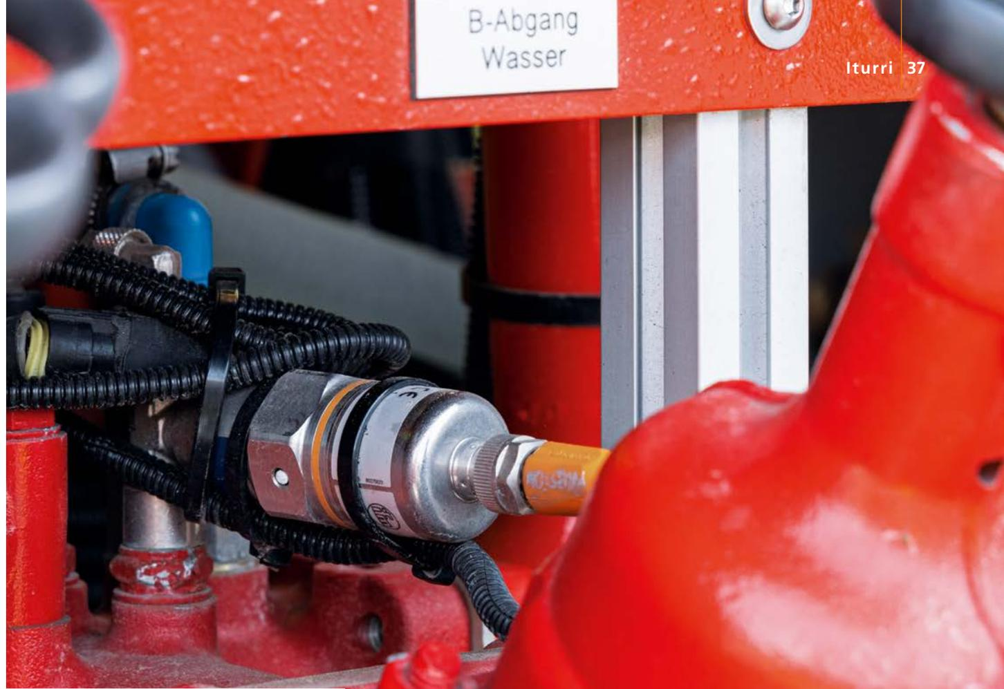
Drucksensor mit E1-Zulassung zur Ermittlung des Wasserdrucks am Strahlrohr.
