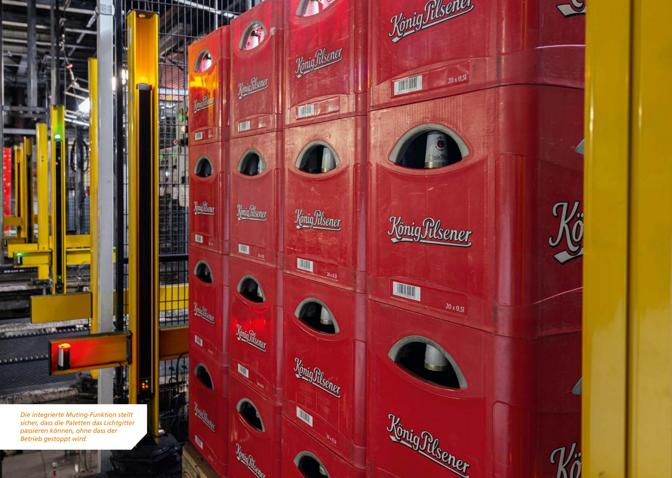
Die integrierte Muting-Funktion stellt sicher, dass die Paletten das Lichtgitter passieren können, ohne dass der Betrieb gestoppt wird.
