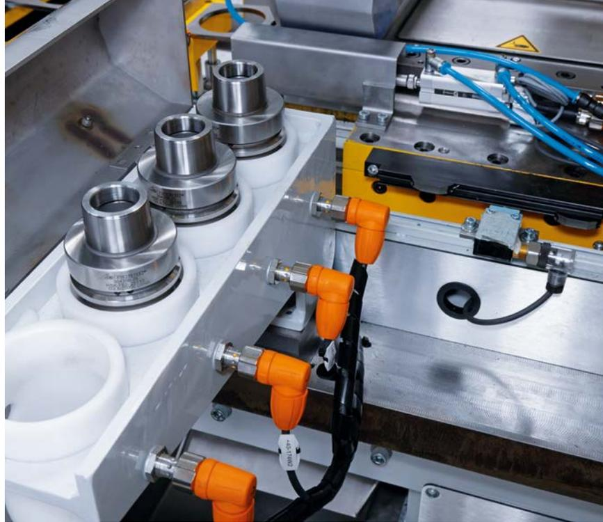
*Anwesenheitskontrolle der Fräsköpfe durch induktive Sensoren (links) sowie exakte Positionierung der Werkstücke vor dem Schweißen per Reflexlichtschranke und präzise Längenmessung per absolutem Multiturn-Drehgeber (unten): Kettec setzt dafür auf Sensorik von ifm.*
