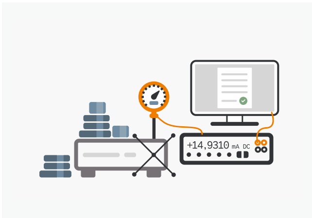
Kalibrierung von Druckmessgeräten anhand von Druckwaagen
