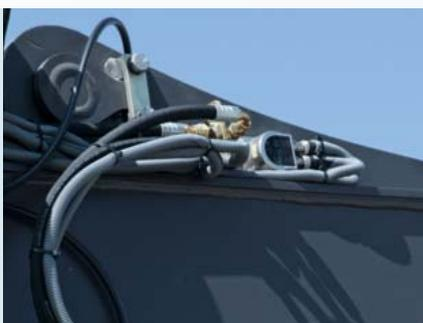
**Sensores de inclinação estáticos tipo JN**
